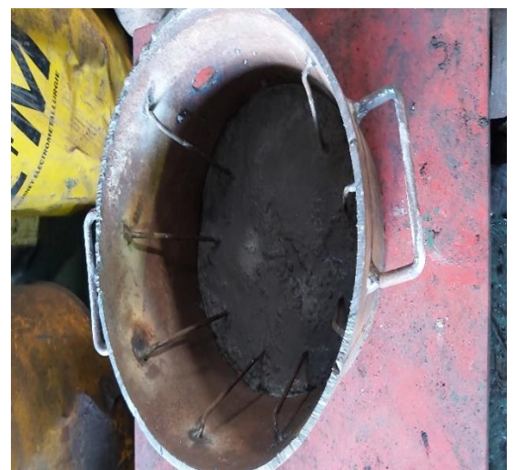
Gambar 45. Pemasangan angker pada badan tanur
