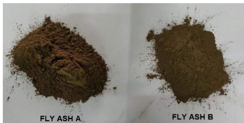
Gambar 1. Material penyusun Mortar Geopolimer : (a) Fly Ash A dan (b) Fly Ash
