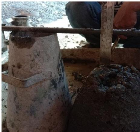
Gambar IV. 2 Pengujian Slump Test
