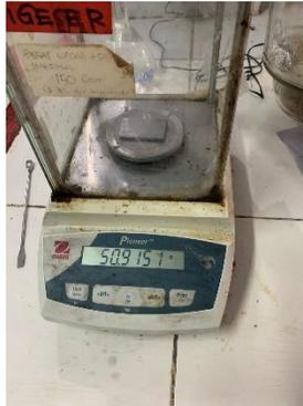
**Gambar IV.4.1** Pengukuran menggunakan neraca analitic
