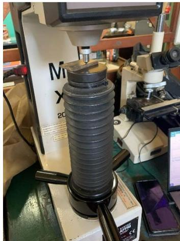
**Gambar IV.5.3** Pengujian Kekerasan Spesimen
