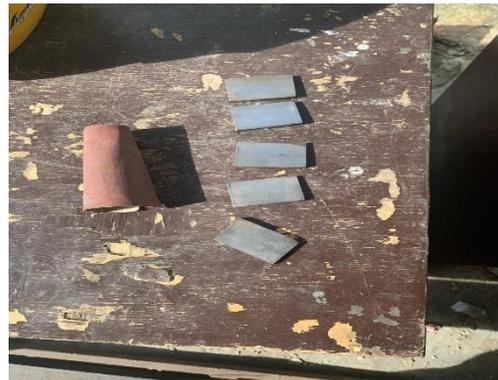
**Gambar IV.2** Pemotongan Egrek sawit menjadi spesimen berbentuk persegi panjang
