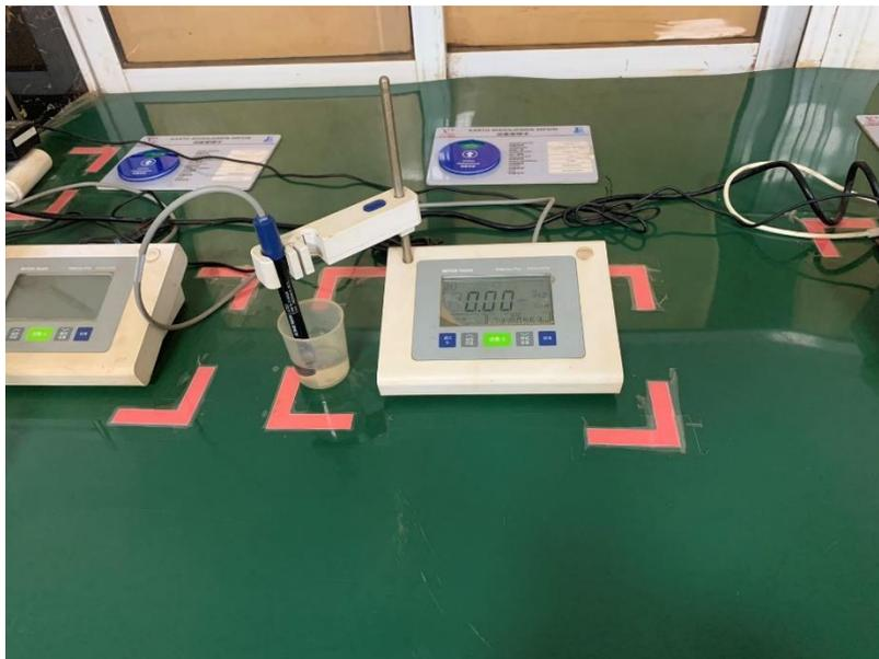
**Gambar 2.2** Alat Konduktivitas Meter
