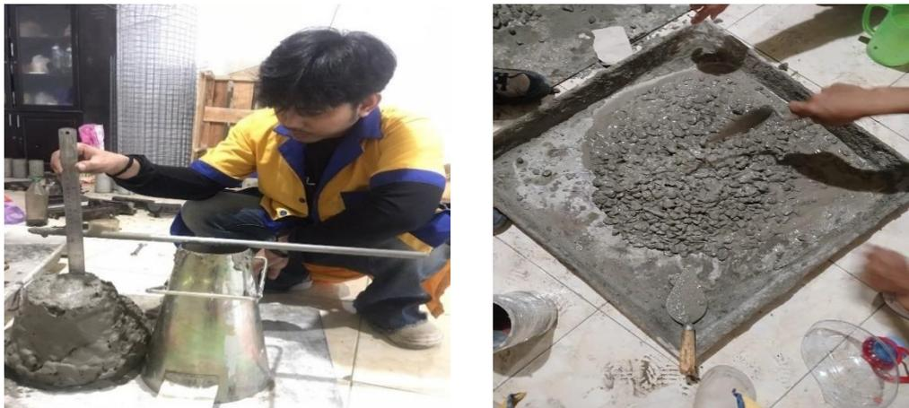
Gambar IV. 2 Uji Slump
