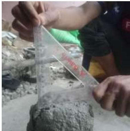
**Gambar IV. 3 Pengujian Slump Test**
