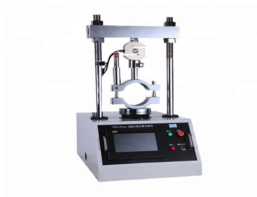
Gambar IV.2 Alat Pengujian Marshall Test
