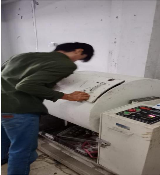
**Proses Pengujian Cantabro TestS**
