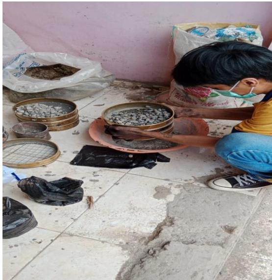
**Proses Penyaringan Agregat**
