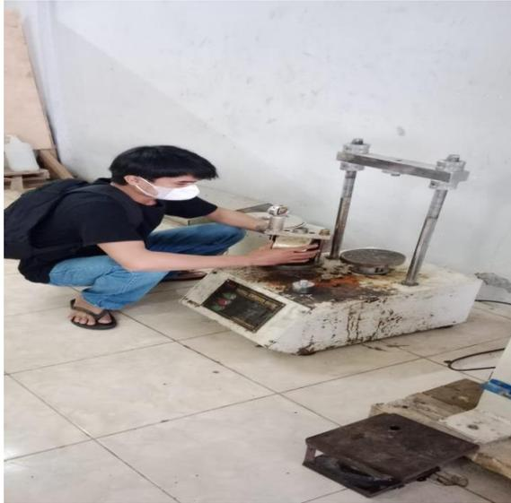
**Pengujian Marshall Test**
