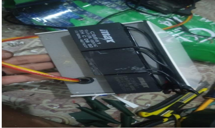
Gambar IV.2. Gambar pada saat hanya kapasitor yang dijadikan beban
