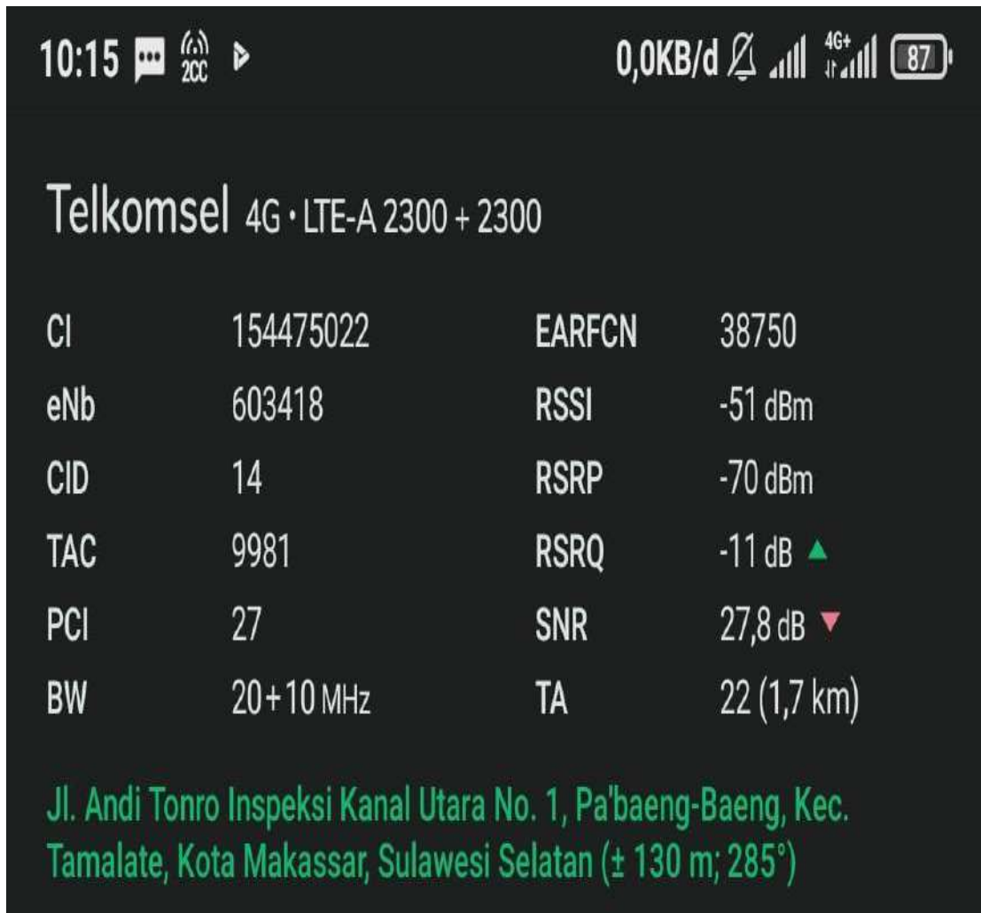
Gambar 4.13 Hasil pengukuran Telkomsel 4G LTE frekuensi 2300 MHz di wilayah profira klinik makassar pada jam 10 pagi di jalan andi tonro
