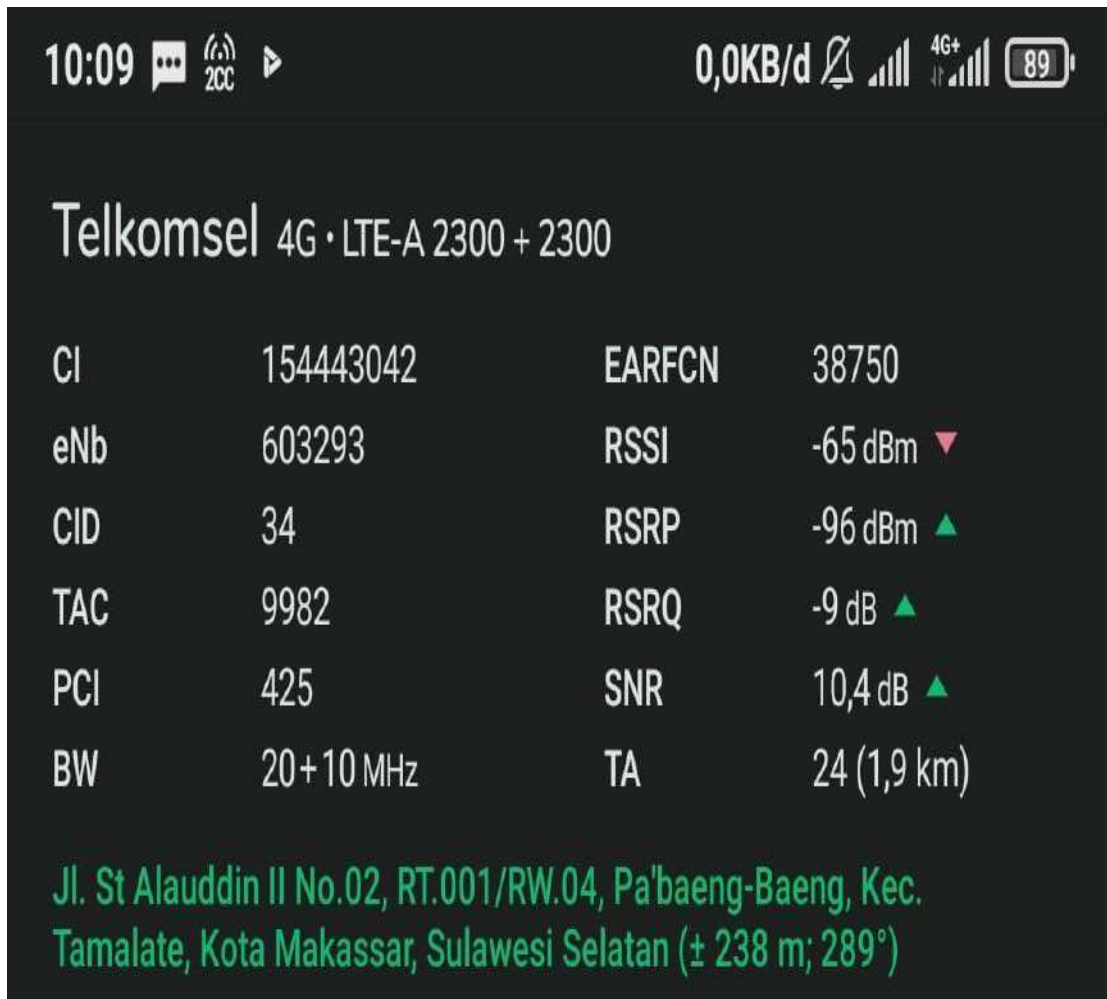
Gambar 4.11 Hasil pengukuran Telkomsel 4G LTE frekuensi 2300 MHz di wilayah profira klinik makassar pada jam 10 pagi di jalan sultan alauddin pabaeng baeng
