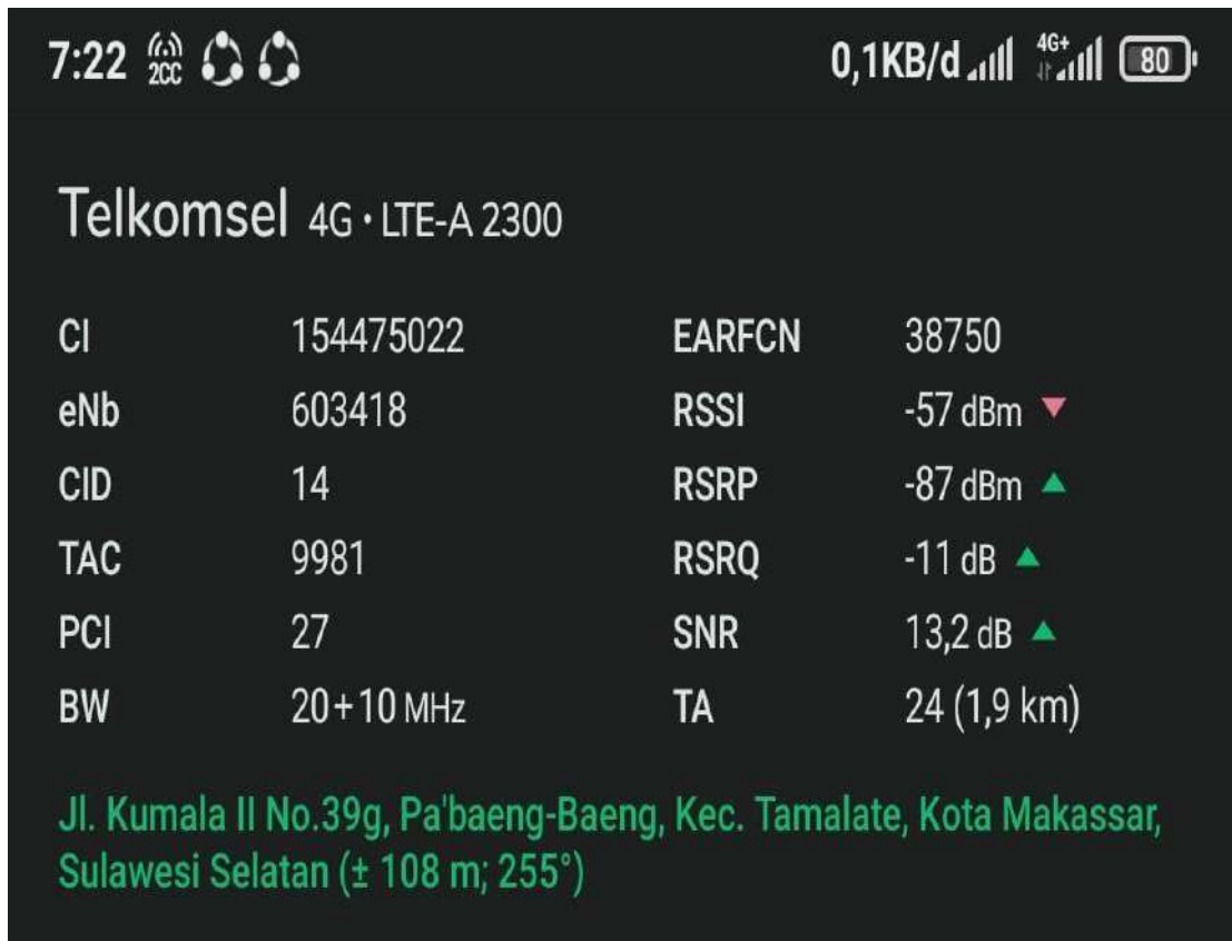
Gambar 4.6 Hasil pengukuran Telkomsel 4G LTE frekuensi 2300 MHz di wilayah profira klinik makassar pada jam 7 pagi di jalan kumala II
