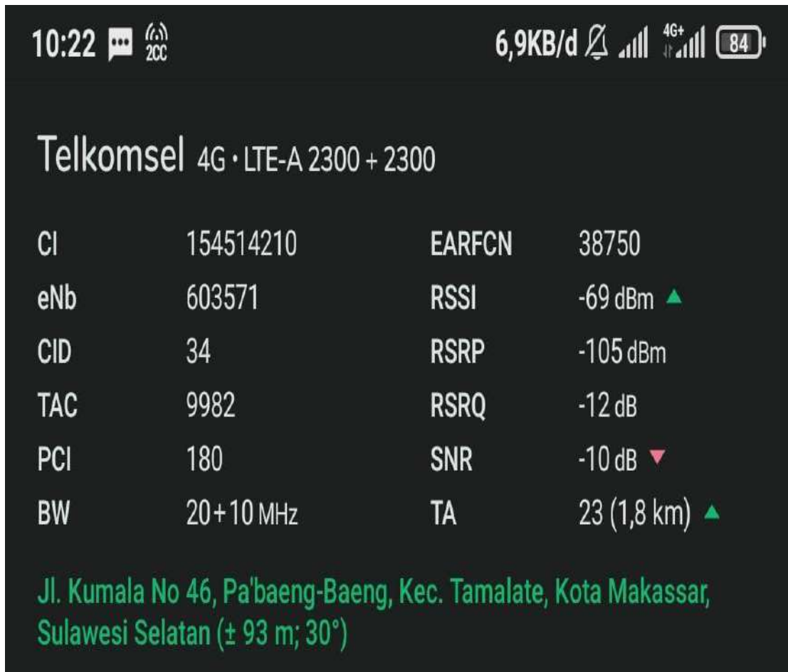
Gambar 4.17 Hasil pengukuran Telkomsel 4G LTE frekuensi 2300 MHz di wilayah profira klinik makassar pada jam 10 pagi di jalan Kumala
