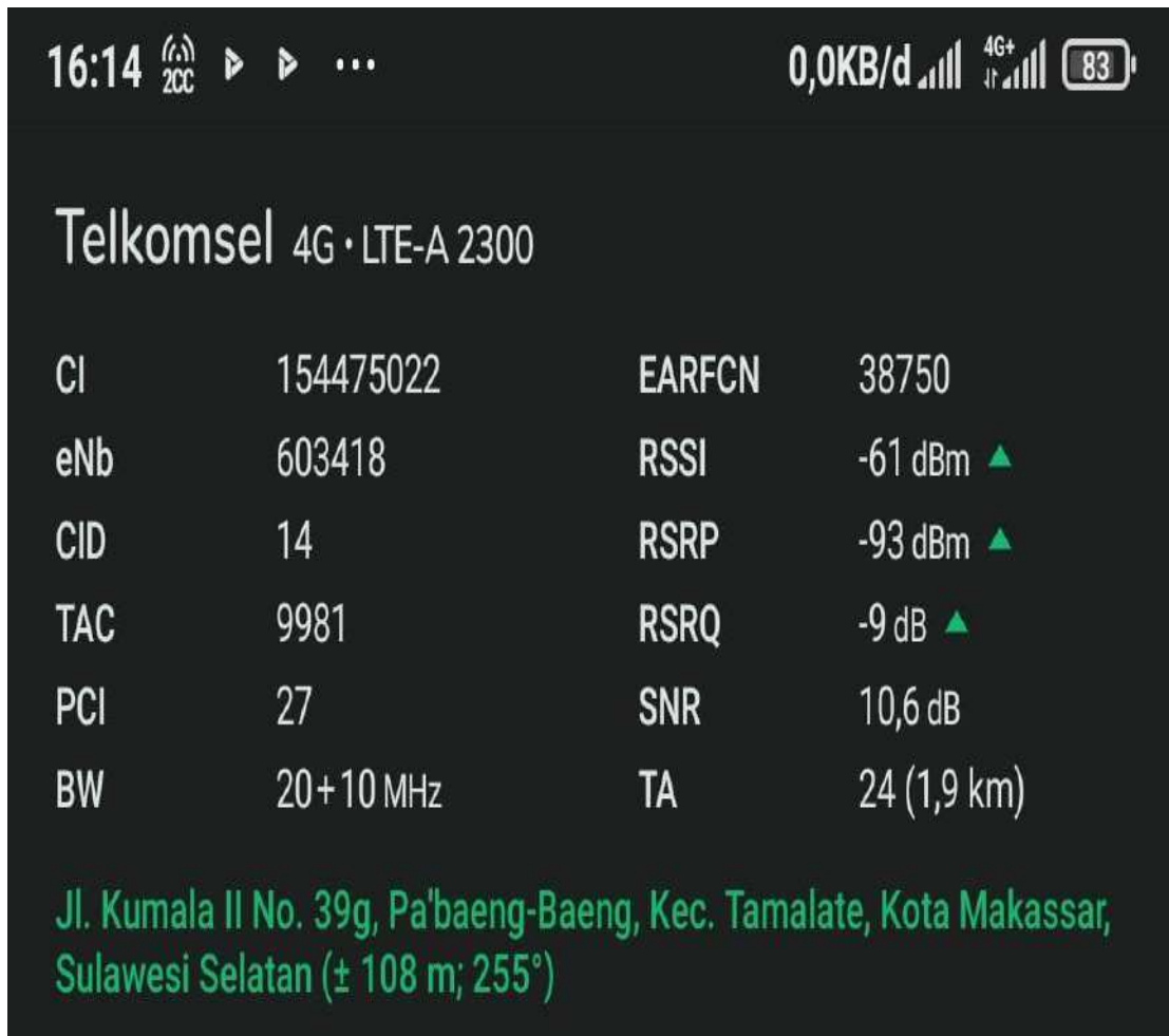
Gambar 4.33 Hasil pengukuran Telkomsel 4G LTE frekuensi 2300 MHz di wilayah profira klinik makassar pada jam 16 sore di jalan kumala II
