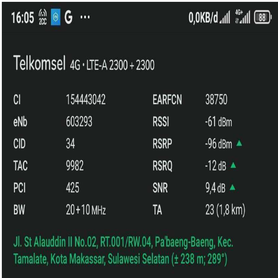
Gambar 4.29 Hasil pengukuran Telkomsel 4G LTE frekuensi 2300 MHz di wilayah profira klinik makassar pada jam 16 sore di jalan sultan alauddin pabaeng baeng
