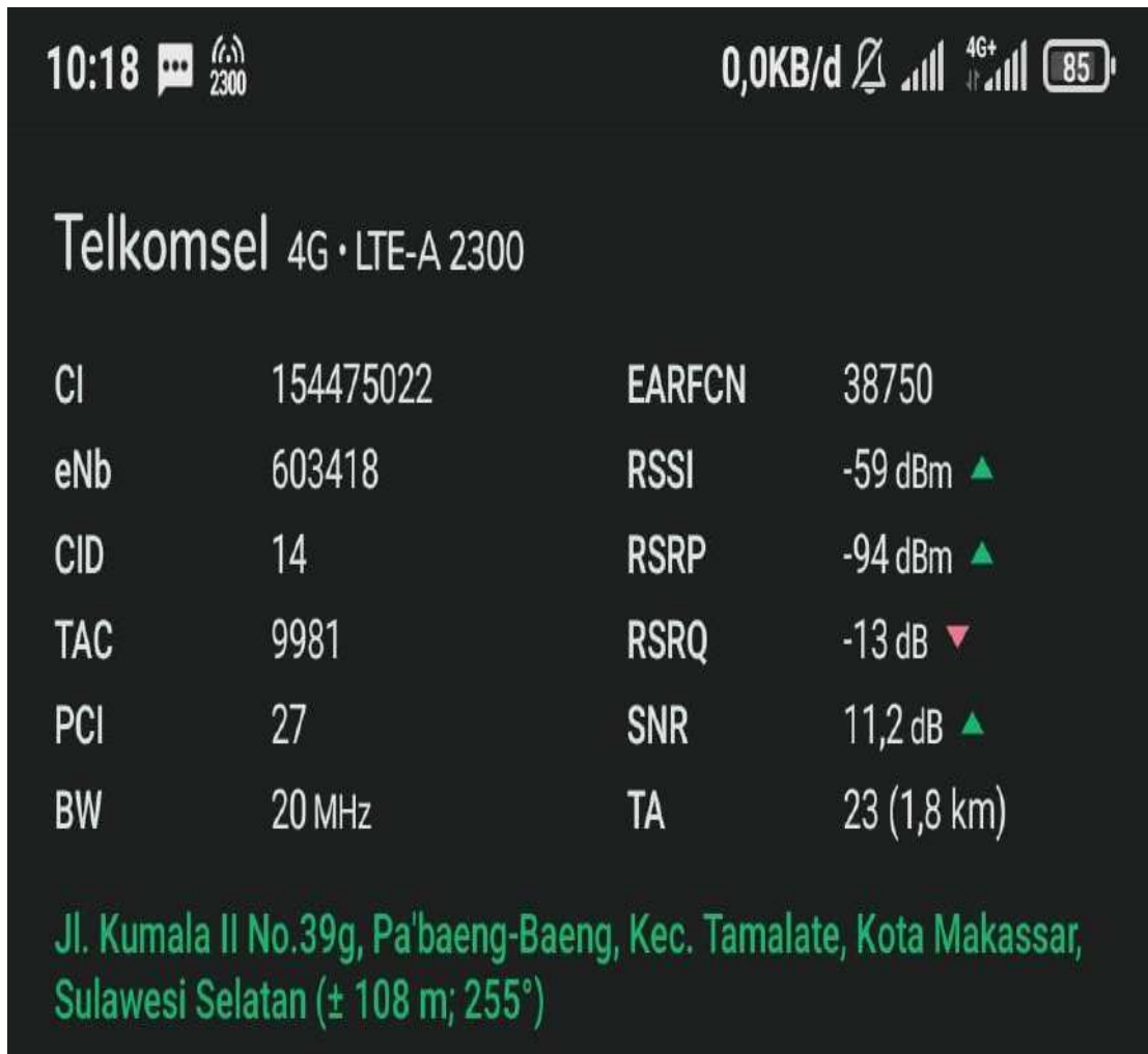
Gambar 4.15 Hasil pengukuran Telkomsel 4G LTE frekuensi 2300 MHz di wilayah profira klinik makassar pada jam 10 pagi di jalan Kumala II
