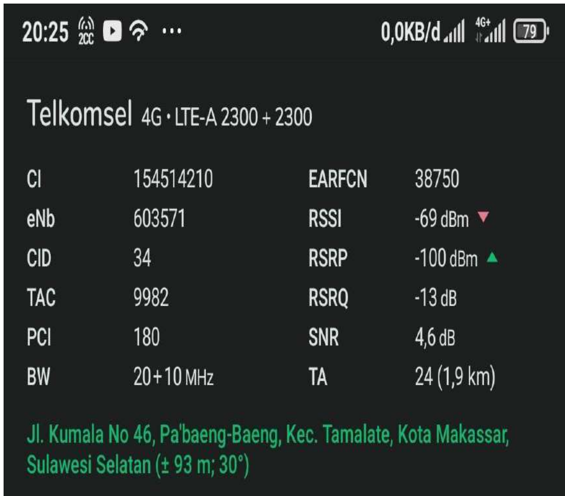
Gambar 4.44 Hasil pengukuran Telkomsel 4G LTE frekuensi 2300 MHz di wilayah profira klinik makassar pada jam 20 malam di jalan kumala
