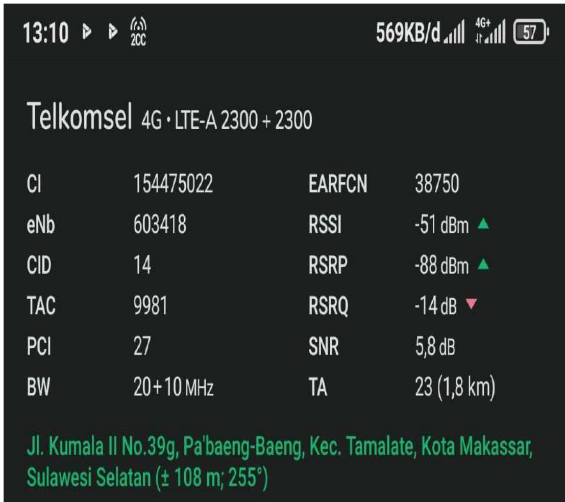
Gambar 4.24 Hasil pengukuran Telkomsel 4G LTE frekuensi 2300 MHz di wilayah profira klinik makassar pada jam 1 siang di jalan kumala II
