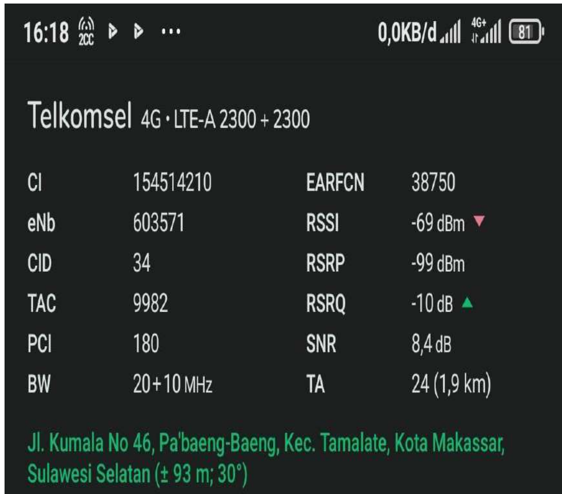
Gambar 4.35 Hasil pengukuran Telkomsel 4G LTE frekuensi 2300 MHz di wilayah profira klinik makassar pada jam 16 sore di jalan kumala
