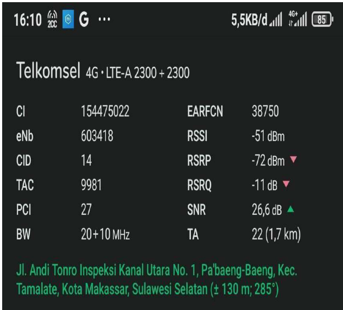
Gambar 4.31 Hasil pengukuran Telkomsel 4G LTE frekuensi 2300 MHz di wilayah profira klinik makassar pada jam 16 sore di jalan andi tonro
