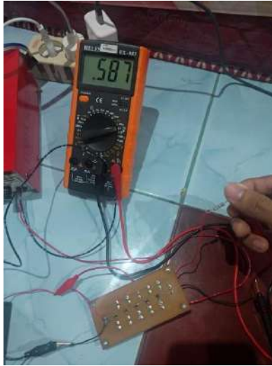
Gambar IV. 22 Pengukuran Menggunakan Tegangan Input 6,5V Dan Beban R_L 22 \Omega
