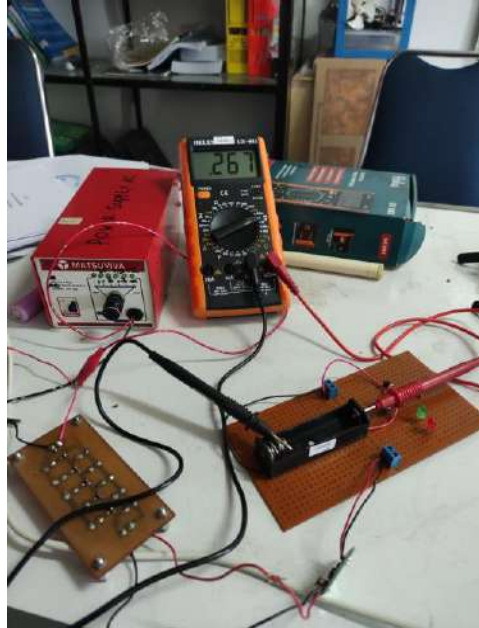
Gambar IV. 25 Hasil Pengukuran Output Rectifier yang diintegrasikan dengan Step up converter dan Rangkaian Penyimpan Input Power Suply AC
