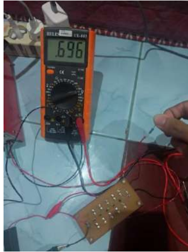
Gambar IV. 24 Pengukuran Menggunakan Tegangan Input 6,53V Dan Beban R_L 5,6 \Omega
