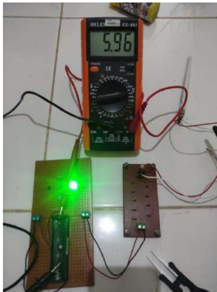
Gambar IV. 31 Hasil pengukuran output tegangan rangkaian dengan menggunakan input antenna Wi-Fi (2400 MHz)
