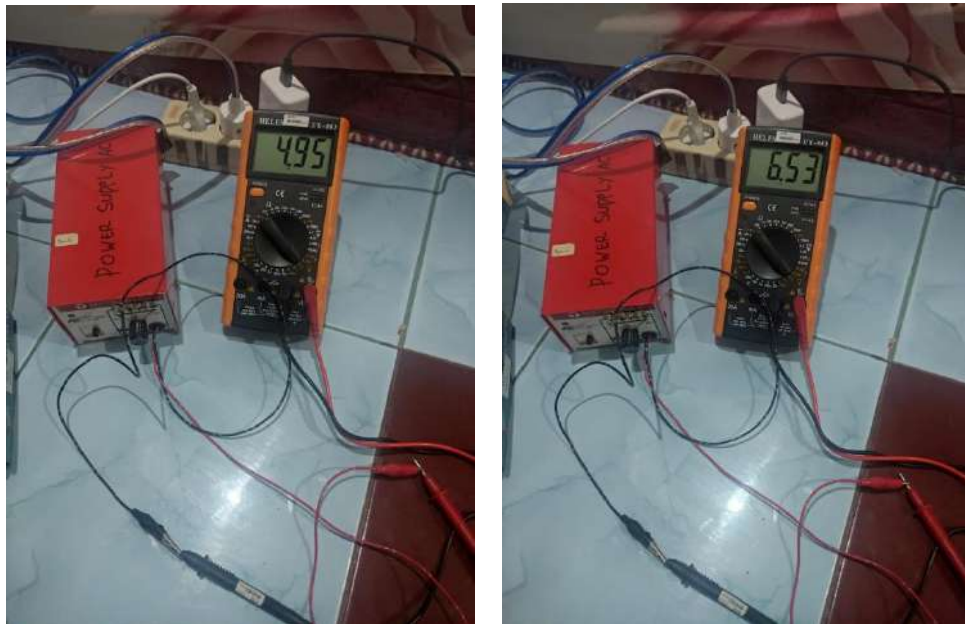
Gambar IV. 15 Pengukuran Output Power Suplly AC 4,9 Volt dan 6,5 Volt
