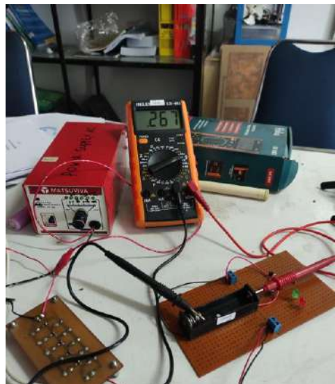
Gambar IV. 5 Pengujian Data rangkaian Penyimpan yang Diintegrasikan dengan Rectifier dan Step up Converter menggunakan Input Power Suply AC
