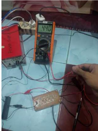
Gambar IV. 17 Pengukuran Menggunakan Tegangan Input 4,9 Volt Dan Beban R_L 27\Omega
