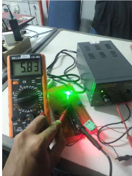
. Gambar IV. 28 Hasil Pengukuran dengan Menggunakan Power Suplly DC Input Tegangan 6 Volt
