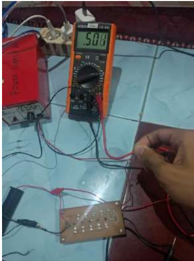
Gambar IV. 19 Pengukuran Menggunakan Tegangan Input 4,95V Dan Beban R_L 10 \Omega
