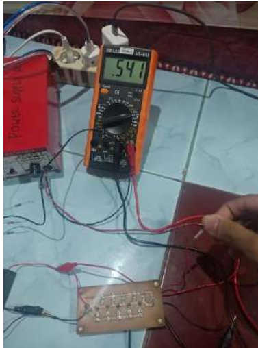
Gambar IV. 21 Pengukuran Menggunakan Tegangan Input 6,5V Dan Beban R_L 27\Omega
