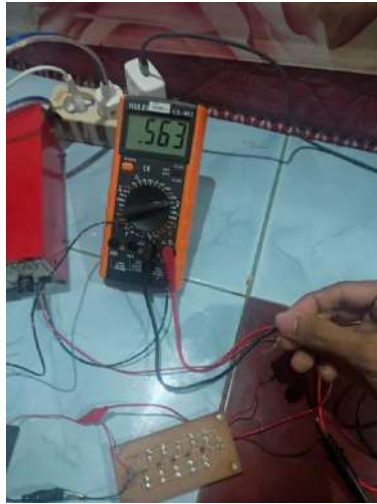
Gambar IV. 18 Pengukuran Menggunakan Tegangan Input 4,9V Dan Beban R_L 22 \Omega
