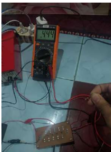
Gambar IV. 20 Pengukuran Menggunakan Tegangan Input 4,95V Dan Beban R_L 5,6 \Omega
