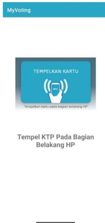
Gambar IV.16 Tampilan Scan E-KTP menggunakan NFC
