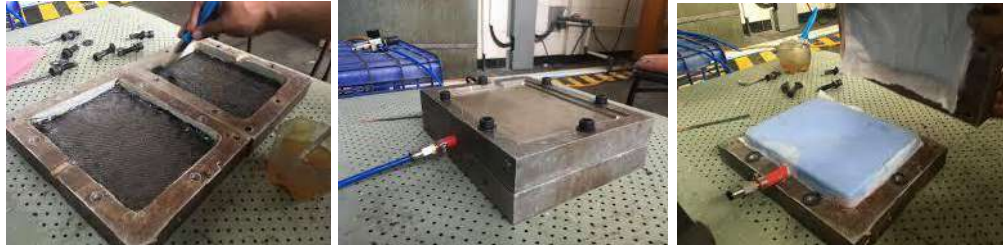
Gambar 3.13 gambar pembuatan komposit dalam cetakan (Sumber: Nugroho G, 2019, Proses Fabrigasi dan Sifat Mekanik Komposit polimer Dengan Metode Bladder Compression Moulding)
