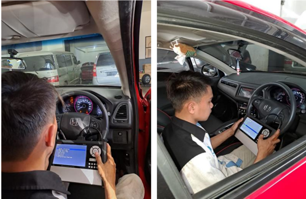
Gambar 7 :Pengambilan Data Pada Mobil Honda Hrv Dengan Keluhan Indikator Abs Menyala
