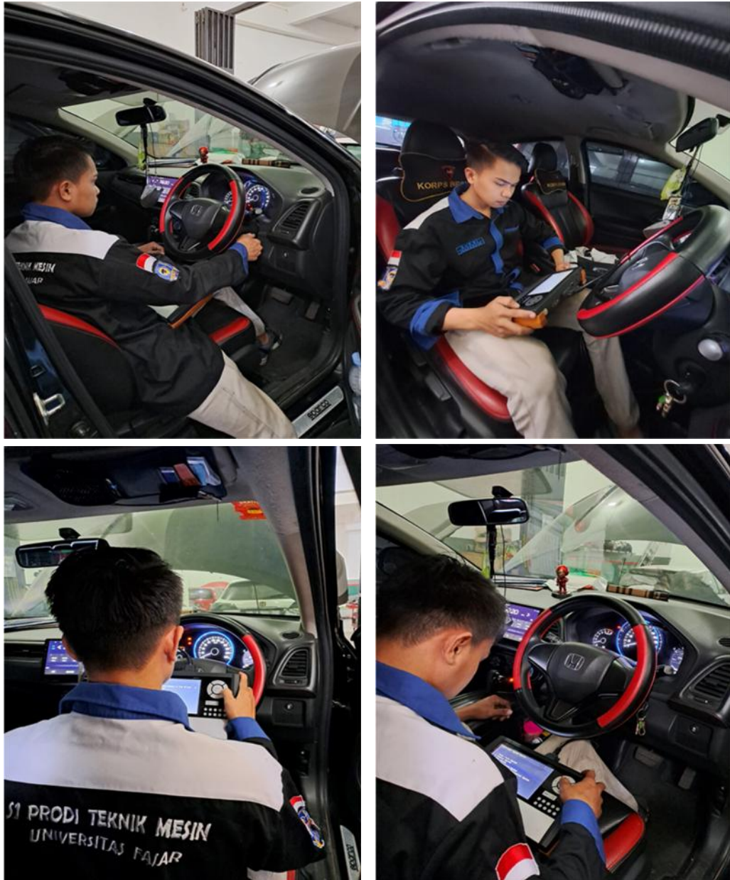
Gambar 2: Pengambilan Data Pada Mobil Hrv Dengan Keluhan Indikator Engine Menyala
