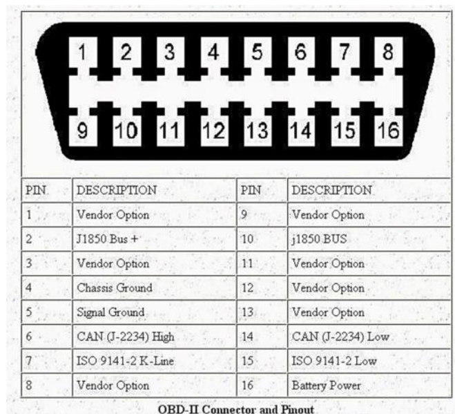
Gambar 2.1 OBD - II Konektor dan Pinout
