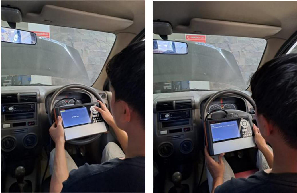
Gambar 3: Pengambilan Data Pada Mobil Toyota Avanza Dengan Keluhan Indikator Engine Menyala
