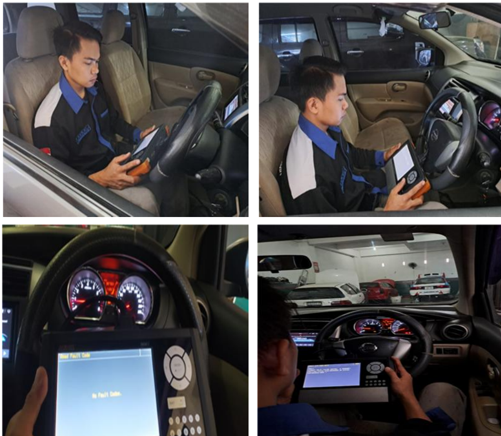
Gambar 6 : Pengambilan Data Pada Mobil Nissan Livina Dengan Keluhan Indikator Lampu Oli Menyala Dan Cek Engine
