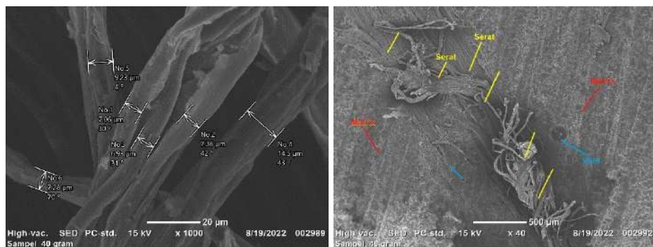
Gambar 4.8 Gambar Struktur Mikro Variasi Serat 40 Gram
