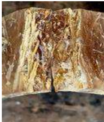
Gambar 4.5 Gambar Patahan Variasi Serat 40 Gram
