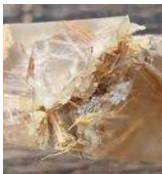
Gambar 4.4 Gambar Patahan Variasi Serat 30 Gram
