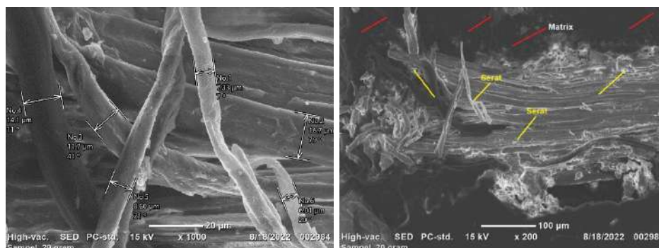
Gambar 4.6 Gambar Struktur Mikro Variasi Serat 20 Gram
