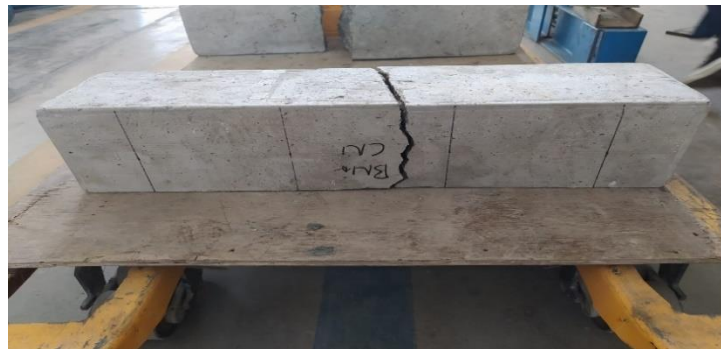
Gambar IV. 7 Model Keretakan Pada Balok Normal
