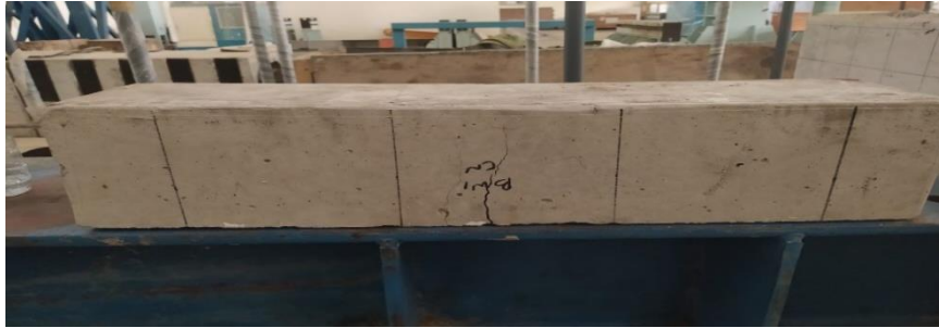
Gambar IV. 8 Model Keretakan Pada Balok wiremesh
