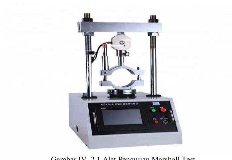
Gambar IV. 2 1 Alat Pengujian Marshall Test
