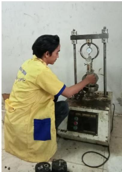
**Pengujian Marshall Test**
