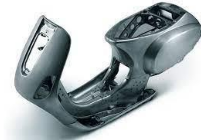
Gambar 2.16 Rangka Monocoque (Rangka Cangkang)
