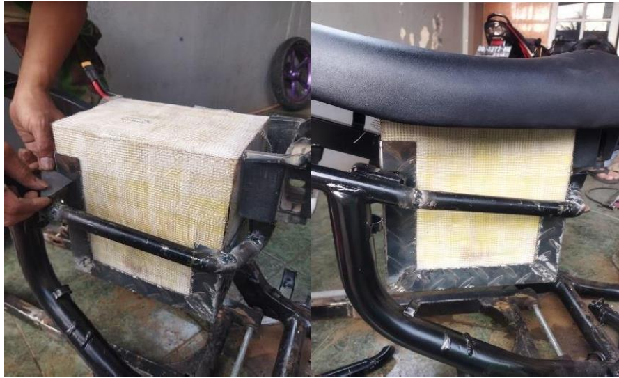
Gambar 4.13 Pemasangan baterai pada dudukan yang telah di buat
