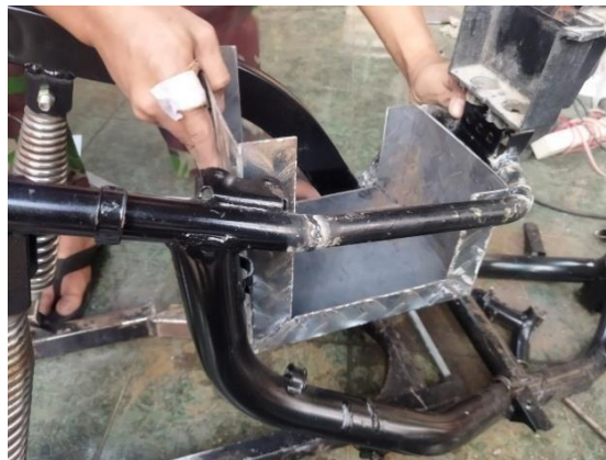
Gambar 4.12 Proses pemasanganudukan baterai pada rangka sepeda motor
