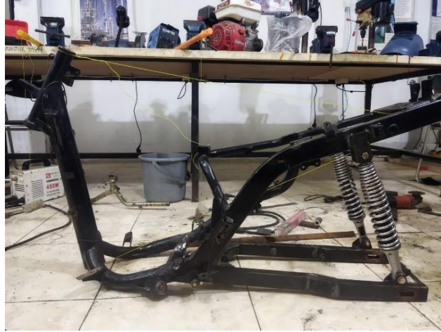
Gambar 4.7 Hasil pemasangan lengan ayun dan shockbreaker pada rangka sepeda motor.
