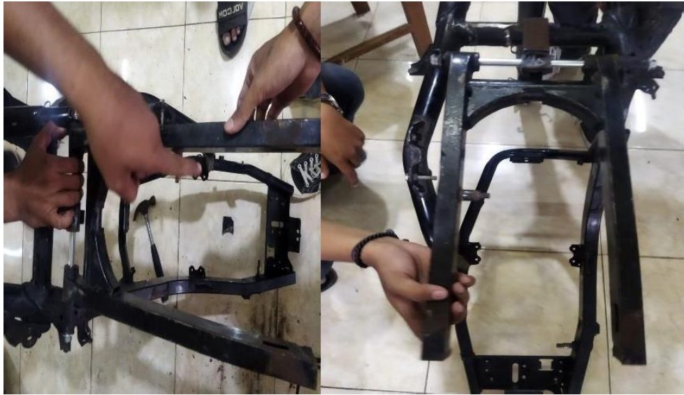
Gambar 4.4 Pemasangan lengan ayun (swing arm)
