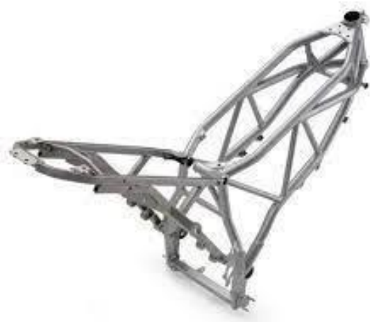
Gambar 2.17 Gambar Trellis (Rangka Teralis)
