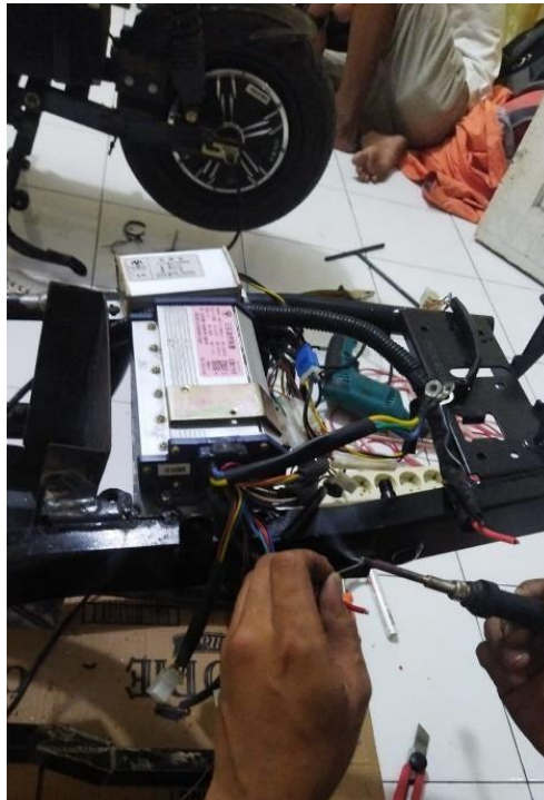
Gambar 4.15 Pemasangan controller pada dudukan yang telah di buat
