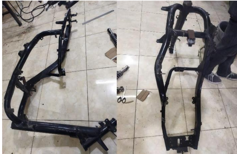
Gambar 4.1 Potongan Rangka Sepeda motor
