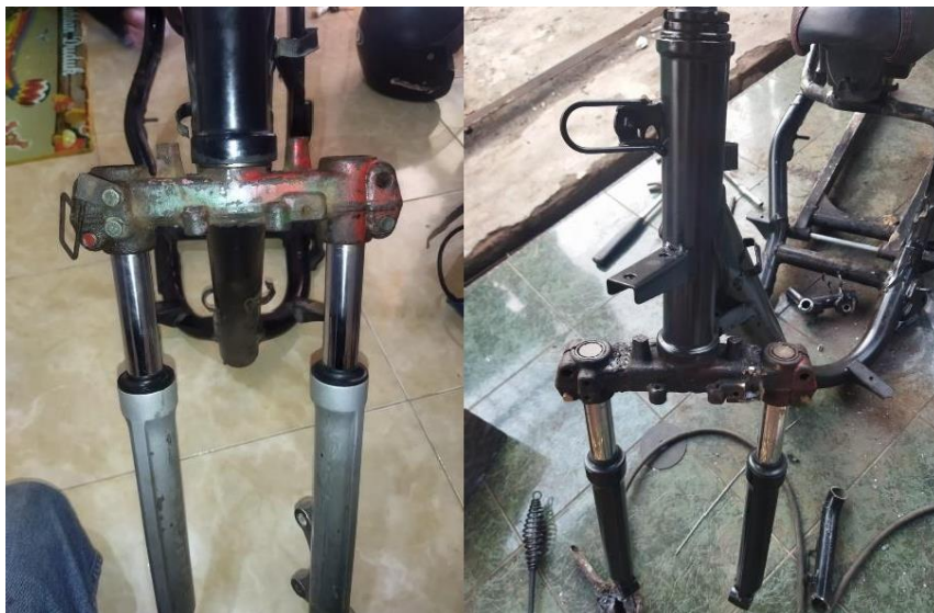
Gambar 4.5 Modifikasi segitiga sepeda motor (under bracket)
