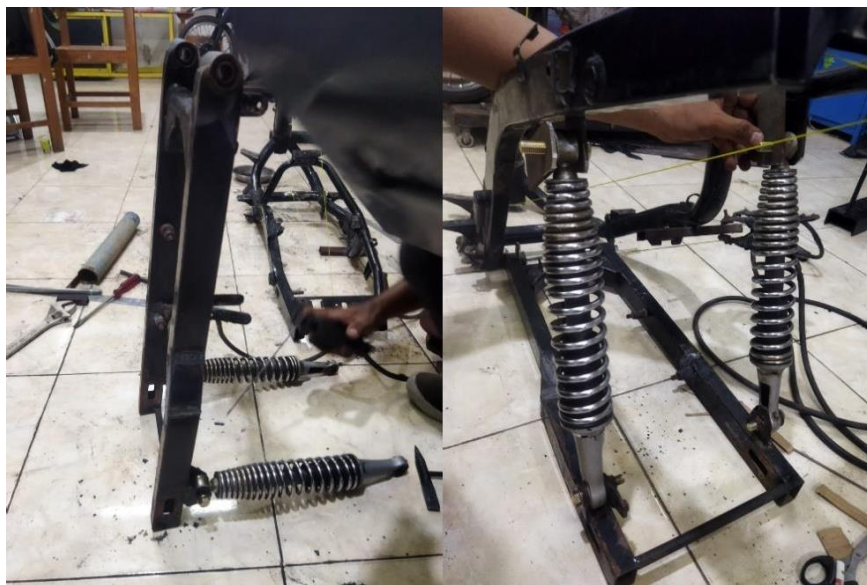
Gambar 4.6 Pemasangan shockbreaker (doble shock)
