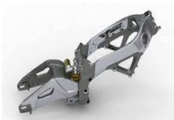
Gambar 2.15 Rangka Beam (Rangka Balok Penyeimbang)
