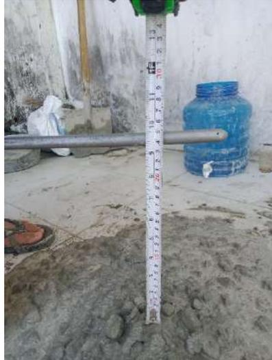
Gambar IV. 2 Uji Slump Tes
