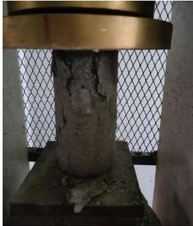
Gambar IV. 3 Pengujian kuat tekan beton
