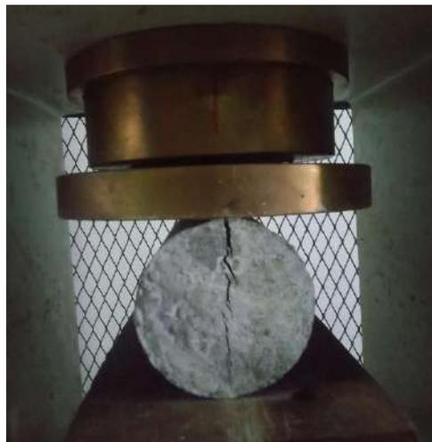
Gambar IV.4 Pengujian Kuat Tarik Belah Beton
