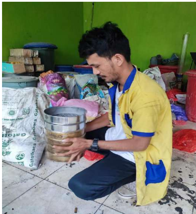
Proses penyaringan agregat
