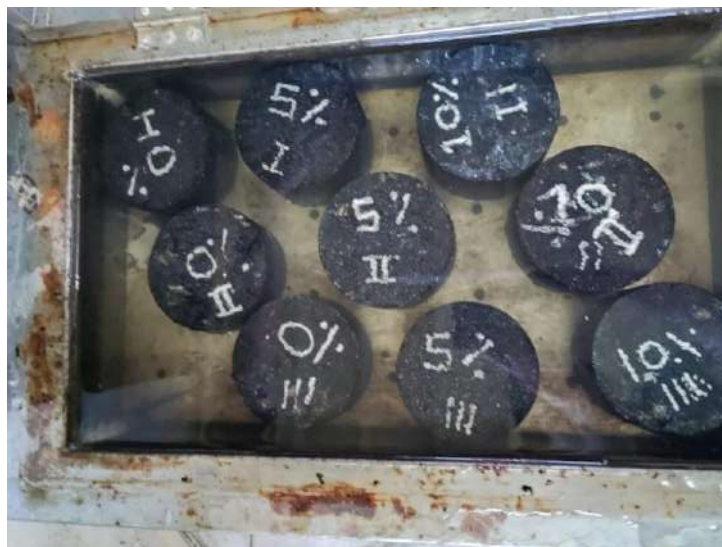
Proses perendaman sampel dalam water bath
