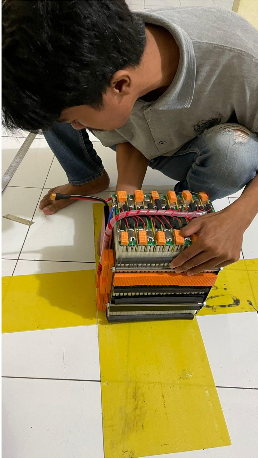
Gambar 4 Pemasangan Akrilik pada baterai
