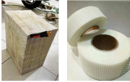
Gambar IV. 12 Baterai litium-ion yang sudah terbungkus isolasi gypsum
