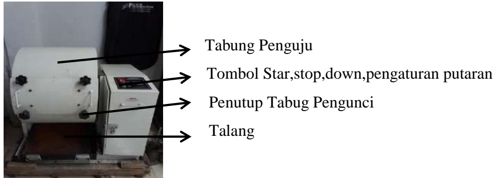
Gambar II.5 Alat pengujian cantabro dengan mesin Los Angeles
