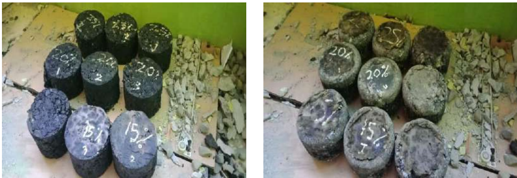
Gambar IV.8 Briket yang sebelum dan sesudah di uji
