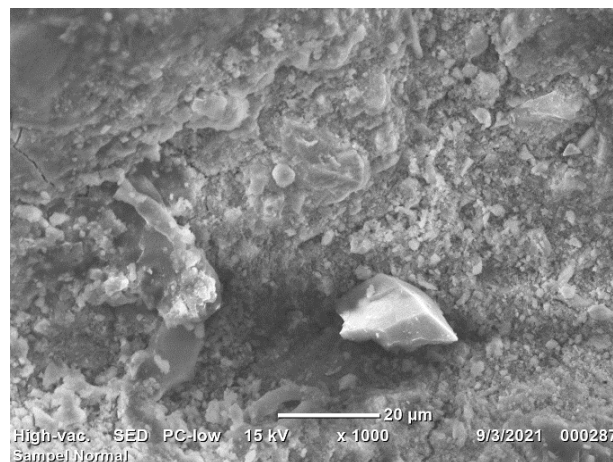
Gambar 4. 4 hasil pengujian SEM beton normal (0% limbah) dengan pembesaran 1000x
