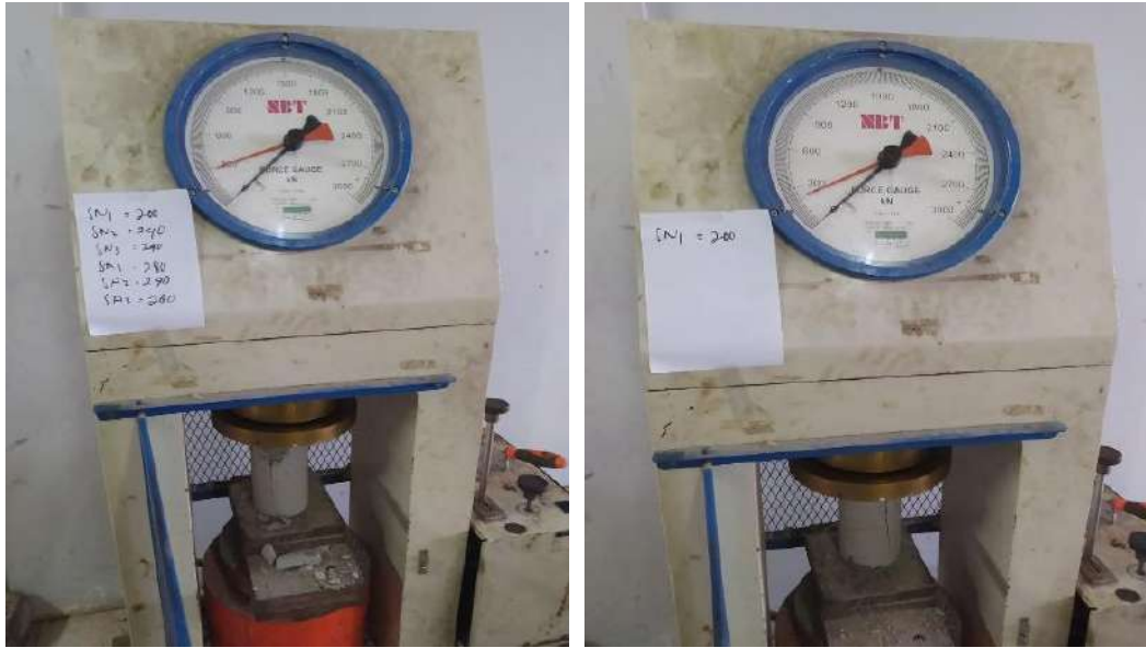
Gambar 11.3 Pengujian Kuat Tekan Benda Uji Silinder
