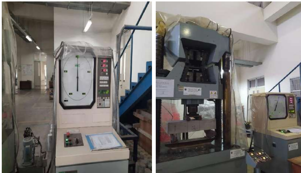
Gambar 11.4 Mesin Pengujian Kuat Lentur
