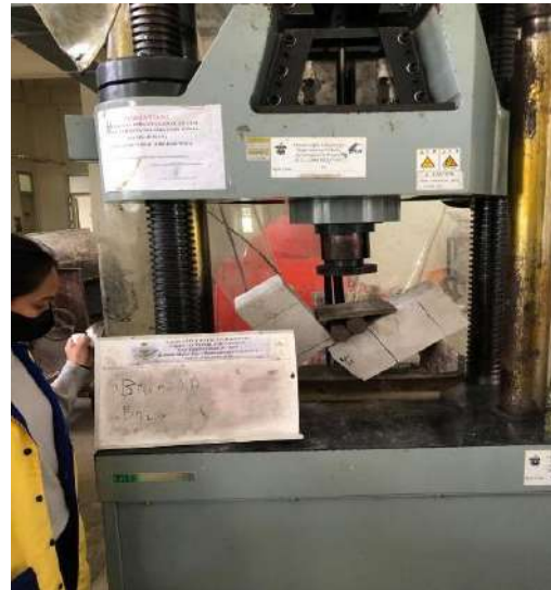
Gambar IV. 5 Hasil Pengujian Balok Normal 28 Hari
