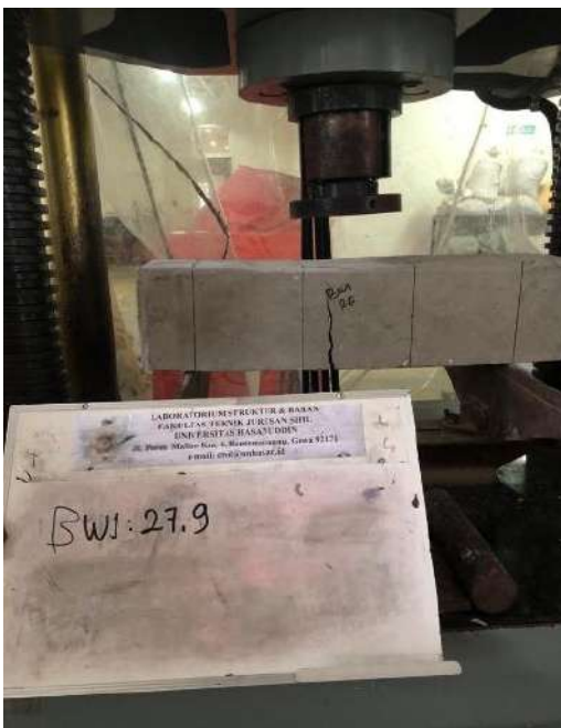
Gambar IV. 6 Hasil Pengujian Balok Wiremesh 28 Hari
