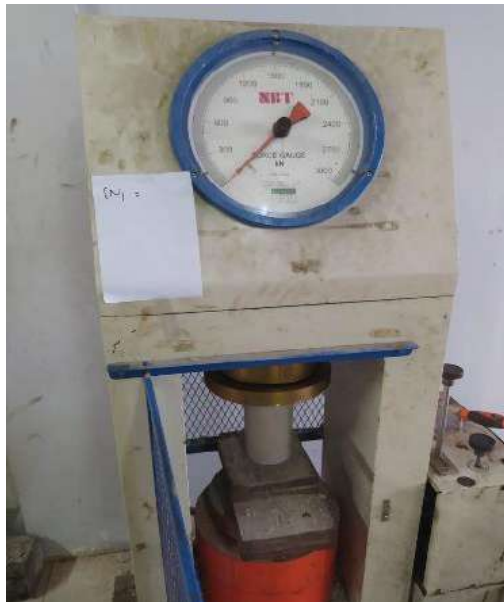
Gambar IV. 2 Pengujian Kuat Tekan Beton Normal (SN)
