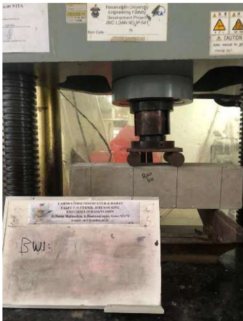
Gambar IV. 6 Hasil Pengujian Balok Wiremesh 28 Hari
