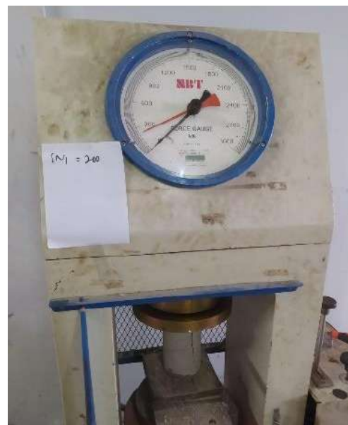
Gambar IV. 2 Pengujian Kuat Tekan Beton Normal (SN)
