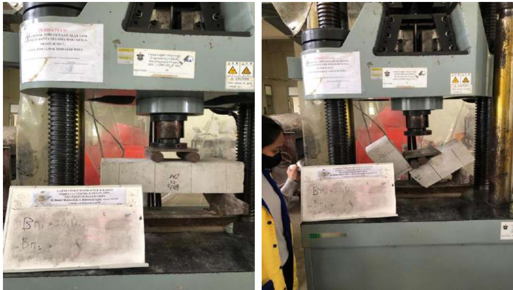
Gambar 11.1 Pengujian Kuat lentur Balok Beton Normal
