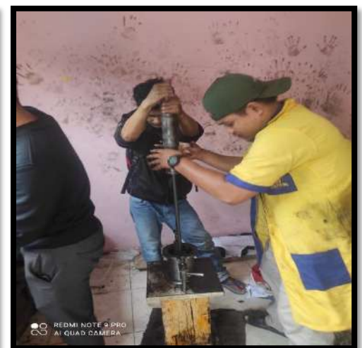
Proses Pemadatan Campuran
