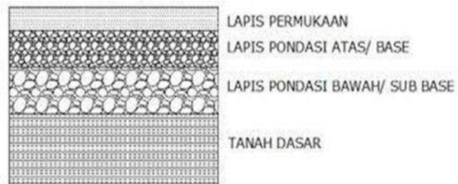
Gambar II.2 Struktur Perkerasan Jalan Lentur
