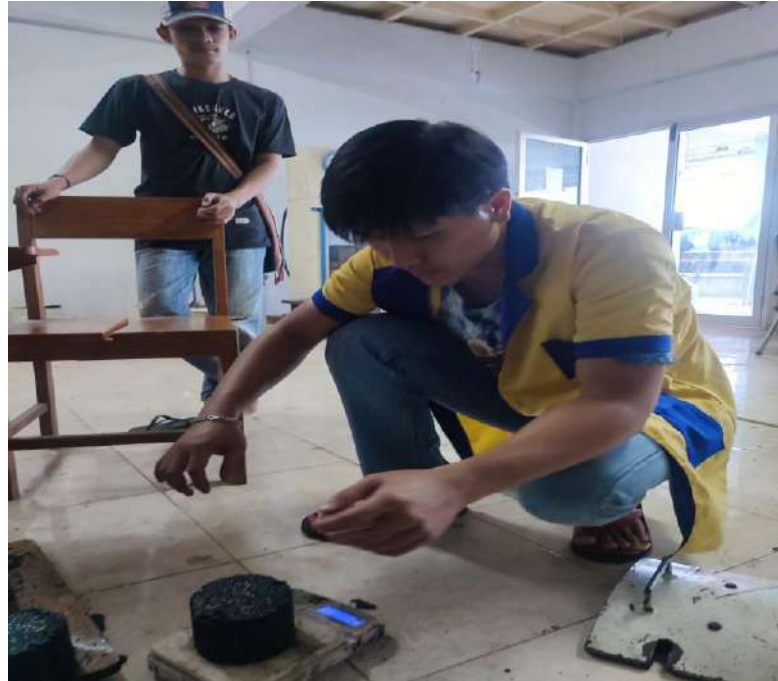
Proses penimbangan benda uji sebelum pengujian cantabro
