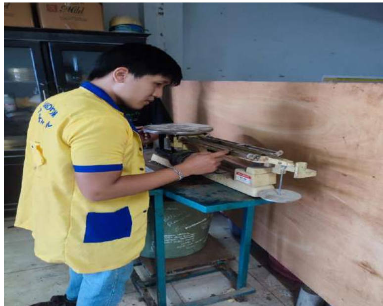
Proses penimbangan sampel dalam air
