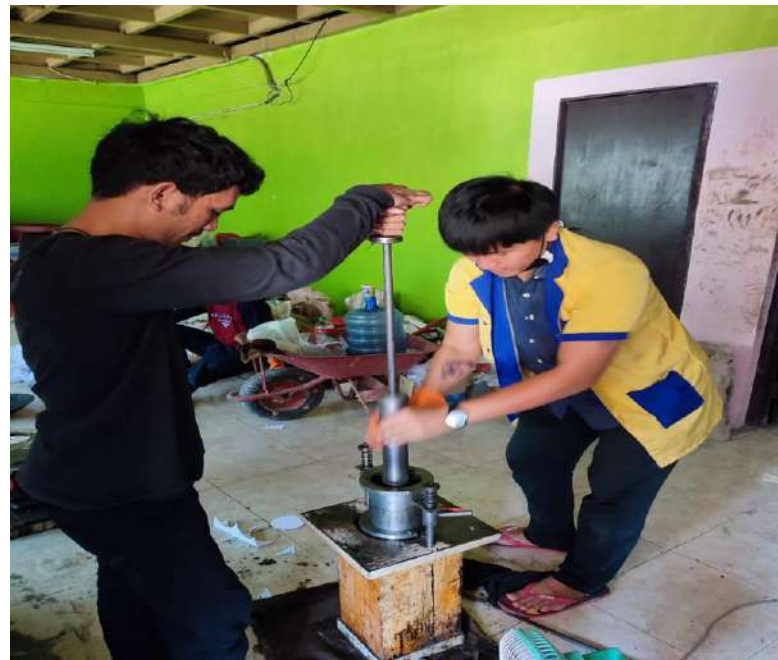
Proses pemadatan benda uji
