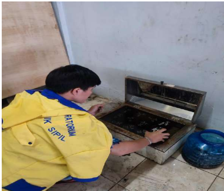
Proses perendaman sampel dalam water bath
