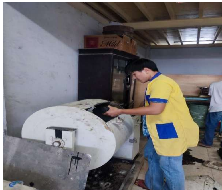
Broses pengujian cantabro
