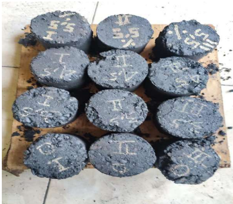
Benda uji sesudah Marshall Test
