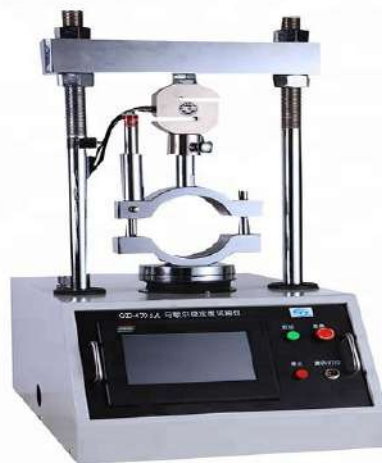
Gambar IV. 2 Alat Pengujian Marshall Test
