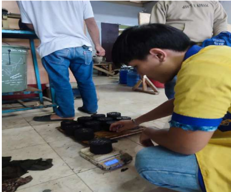
Proses penimbangan sampel dalam keadaan SSD
