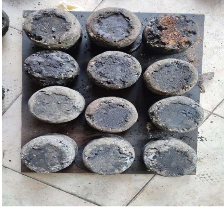
Benda uji sesudah pengujian cantabro
