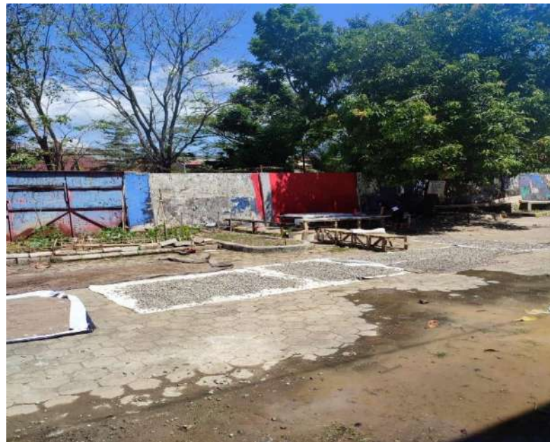
Proses penjemuran agregat kasar dan halus
