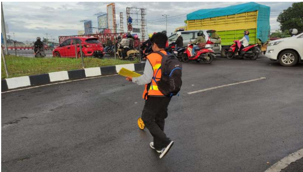
Gambar 17 Pengukuran Geometrik Lebar pada Ruas Jalan Dakota
