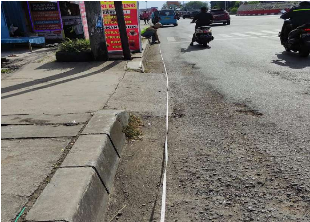
Gambar 18 Pengukuran Panjang Antrian pada Ruas Jalan Tol Ir. Sutami
