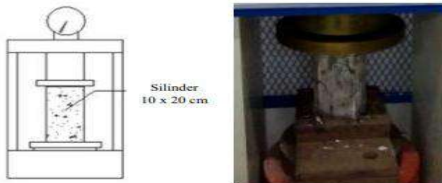
Gambar III. 3 Alat Uji Kuat Tekan Beton (sumber: musahir, 2021)
