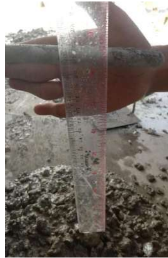
Gambar IV.5 Pengujian Slump Variasi Fly Ash 10%
