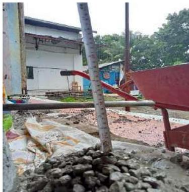
Gambar IV. 1 Slump Test
