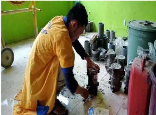
Pembongkaran Beton Silinder
