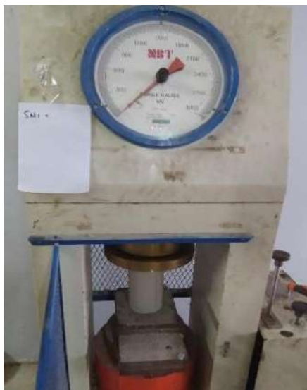
Gambar IV. 2 Pengujian Kuat Tekan Benda Uji Silinder Normal (SN)
