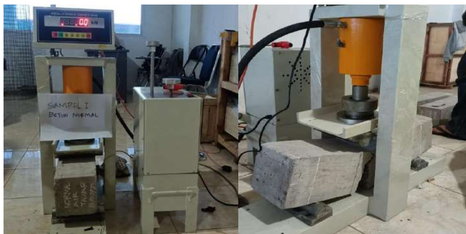
Gambar IV. 3 Pengujian Kuat Lentur Benda Uji Balok Beton Normal
