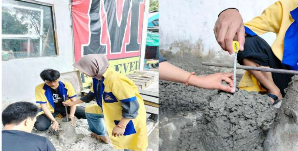
Gambar IV. 1 Pengujian Slump Text (Sumber : pengolahan data)
