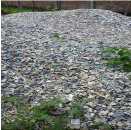
Gambar II. 2 Agregat Limbah Beton (sumber: www.arstik.in )
