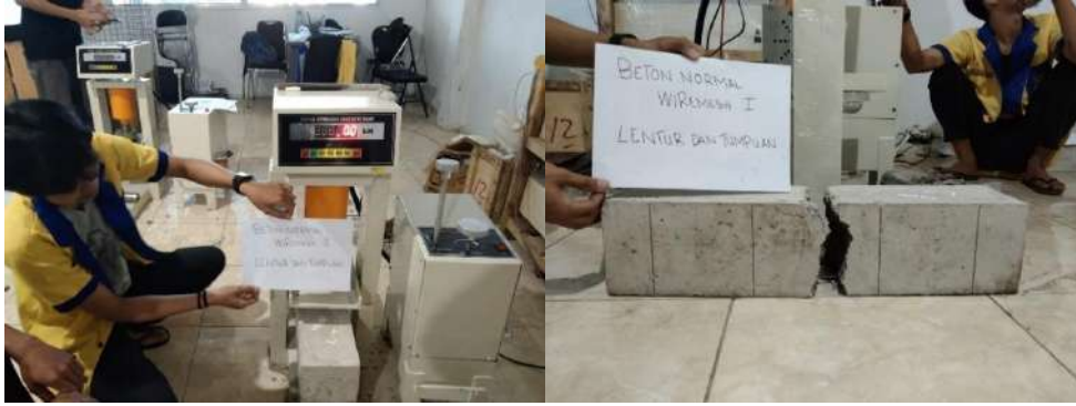
Gambar IV. 4 Pengujian Kuat Lentur Benda Uji Balok Beton Normal Wiremes
