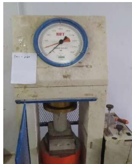
Gambar IV. 2 Pengujian Kuat Tekan Benda Uji Silinder Normal (SN)
