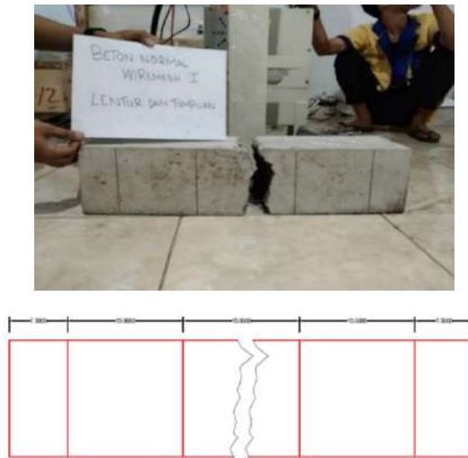
Gambar IV. 10 Pola Retak Benda Uji Balok Beton Normal Wiremesh 1
