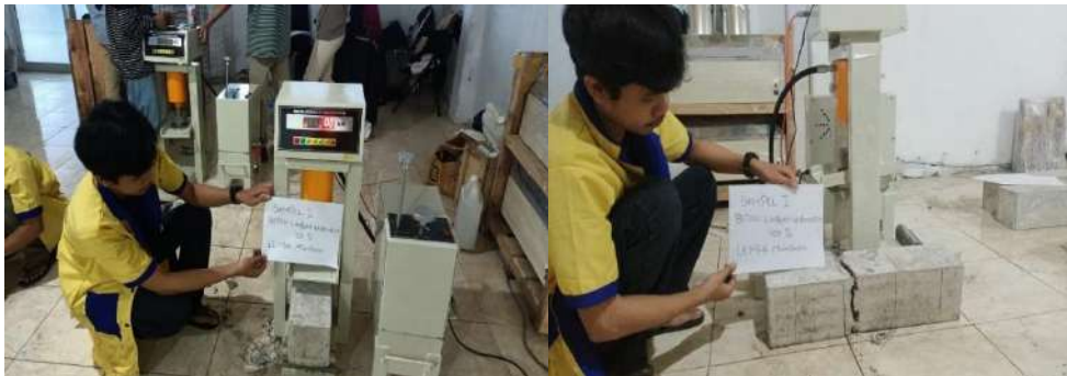
Gambar IV. 5 Pengujian Kuat Lentur Benda Uji Balok Beton Limbah Wiremesh 100%
