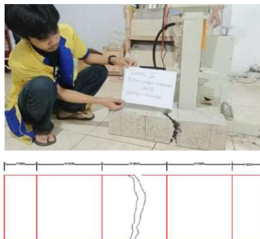
Gambar IV. 14 Pola Retak Uji Balok Limbah Beton Wiremesh Variasi 100% 2
