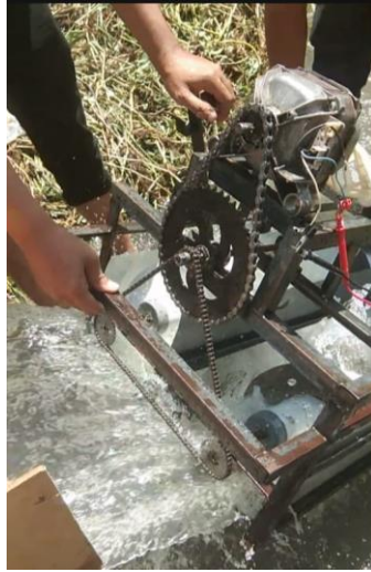
Gambar IV.6 Pemasangan Rantai & Gear
