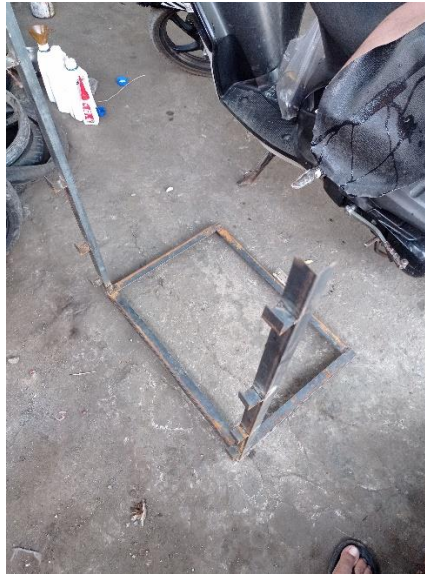
Gambar IV.4 Rangka Dudukan Alat
