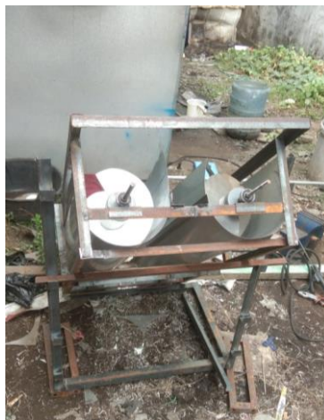
Gambar IV.7 Rangka Dan Dudukan Rangka Turbin
