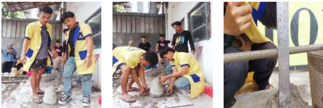
Gambar IV. 1 Pengujian slump Test
