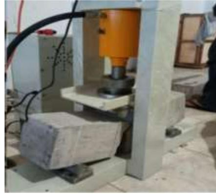
Gambar IV. 3 Pengujian Kuat Lentur Balok Beton Normal
