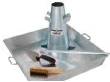
Gambar II. 1 Alat Uji Lump test
