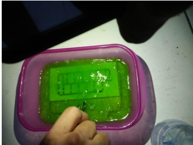
Gambar IV.12 Proses pelarutan PCB dengan larutan Ferric Chloric ( \text{FeCl}_3 ).
