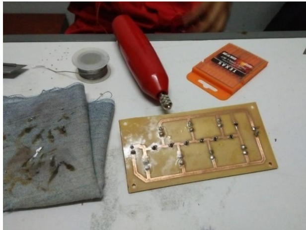
Gambar IV.14 Proses penyolderan rangkaian dan komponen.
