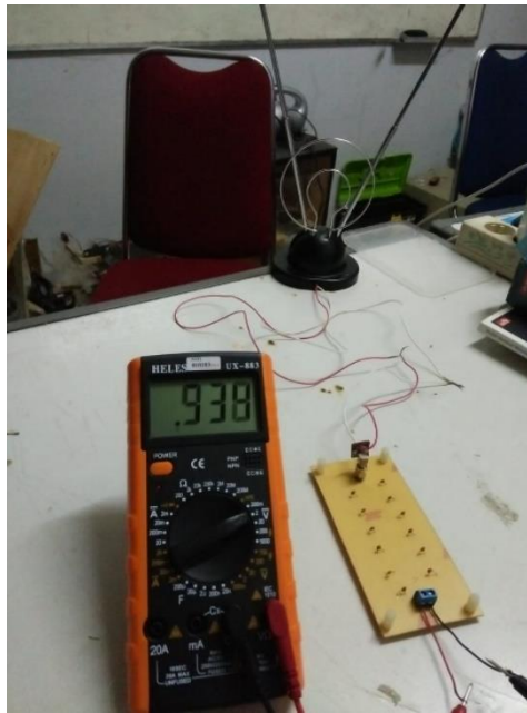
Gambar IV.19 Hasil Pengukuran Output tegangan rectifier menggunakan antena TV Indoor .
