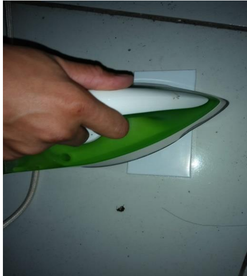
Gambar IV.11 Rangkaian pada kertas kingstruk direkatkan pada papan PCB dengan cara dipanaskan menggunakan setrika.
