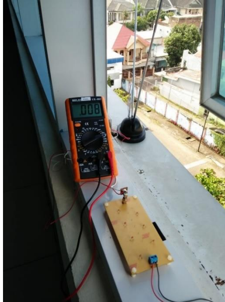
Gambar IV. 3 Output antenna TV rangkaian rectifier dengan komponen diode Schottky HSMS 2822.
