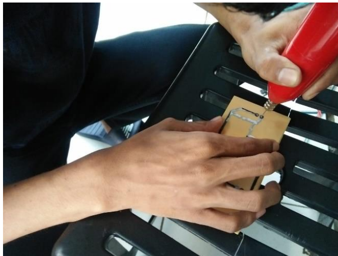
Gambar IV.13 Proses pengeboran pada papan PCB.
