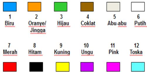
Gambar II. 13 Urutan Core pada kabel optik (Hardjono,2006)
