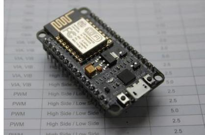
Gambar II.4 Nodemcu V2
