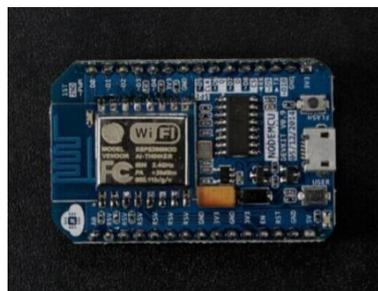
Gambar II.3 Nodemcu V1
