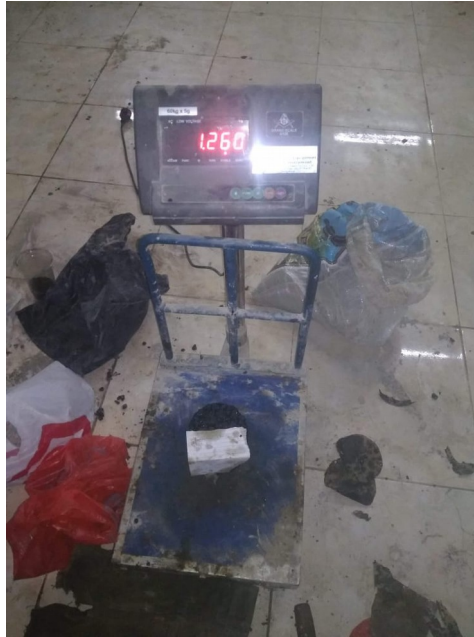
Gambar IV.9 benda uji sebelum pengujian cantabro
