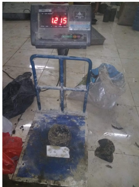
Gambar IV.10 benda uji setelah pengujian cantabro
