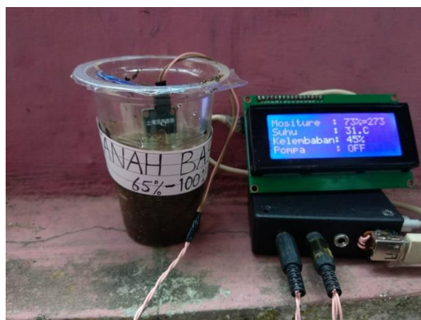
Gambar 4.5 kondisi tanah basah
