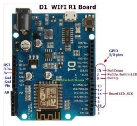
Gambar 2.1 Bentuk Fisik Mikrokontroler Wemos
