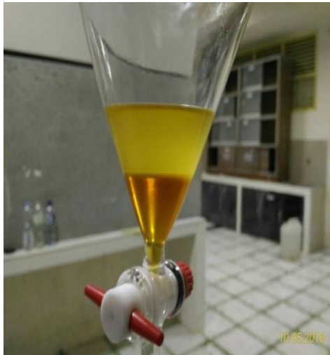
Gambar 5. Hasil Transesterifikasi Menggunakan Mikrowave
