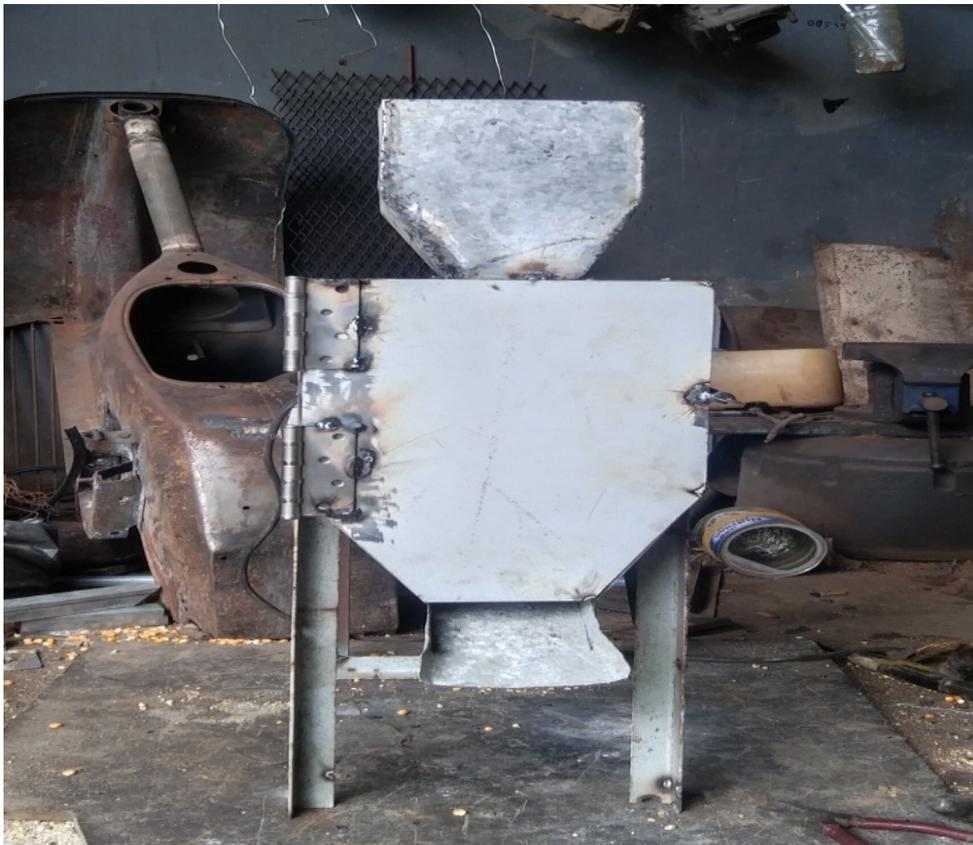
*Gambar 4.1 Mesin Dinamo Pompa Air Menjadi Mesin Penggiling Biji-bijian*
