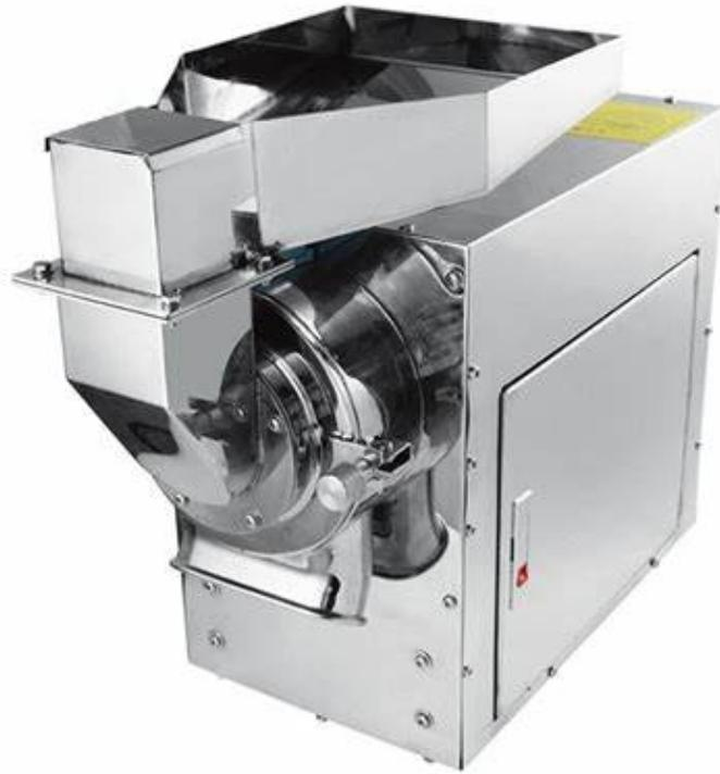
Gambar 2.6 Mesin Penggiling Tepung
