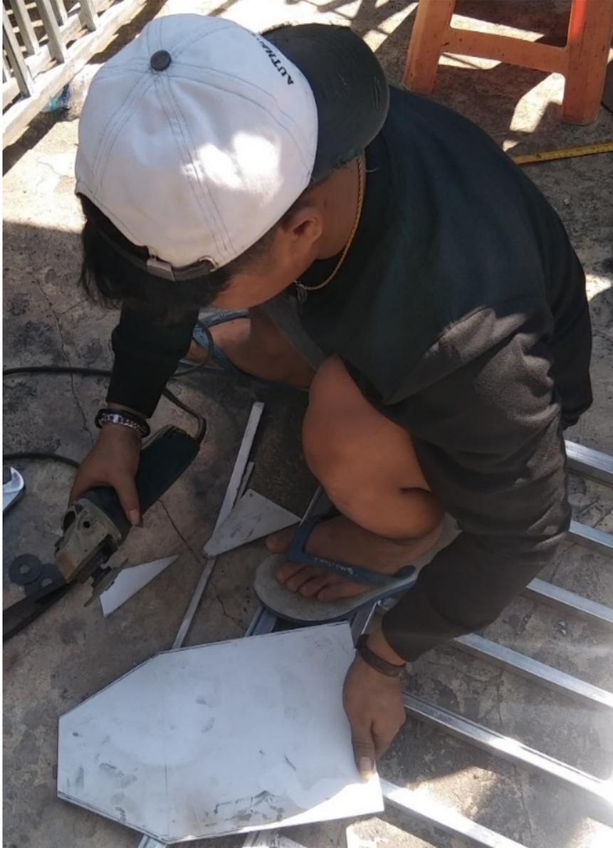
Gambar 3 Proses Pemotogan Cover Tabung
