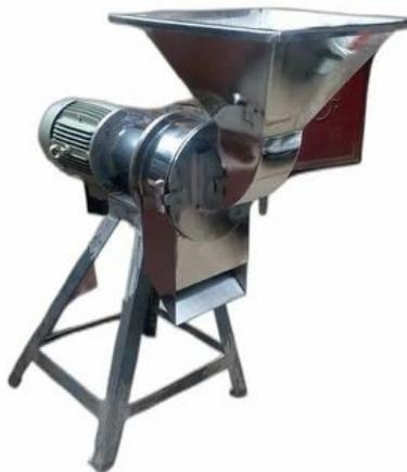
Gambar 2.7 Mesin Penggiling Jangung
