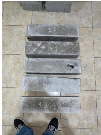
Gambar IV. 12 Benda Uji Kuat Lentur Masing-Masing Variasi
