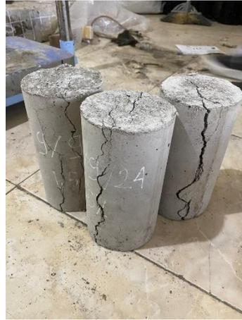
Gambar IV. 9 Perbandingan Pola Retak Beton 0% dan Beton 1,5%
