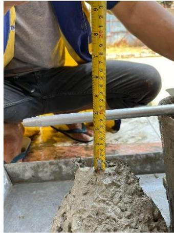
Gambar IV. 2 *Slump Test* Beton Serat Rambut Manusia
