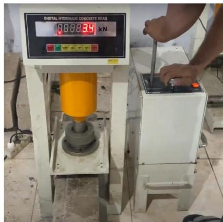
Gambar IV. 10 Pengujian Kuat Lentur Beton Serat Rambut Manusia
