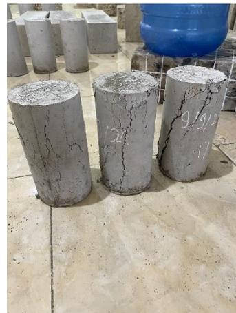
Gambar IV. 6 Perbandingan Pola Retak Beton 0% dan Beton 1%
