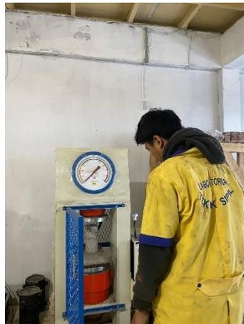
Gambar IV. 4 Pengujian Kuat Tekan Beton Serat Rambut Manusia
