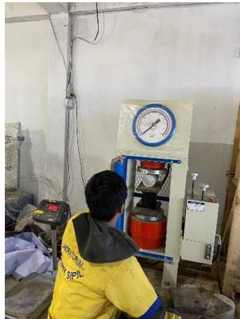
Gambar IV. 7 Pengujian Kuat Tarik Belah Beton Serat rambut manusia
