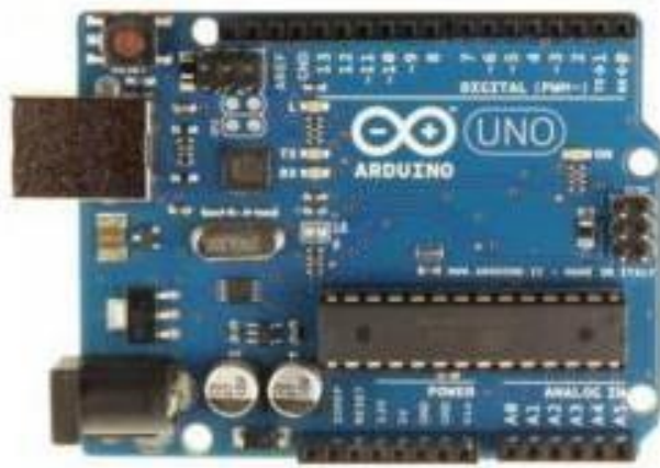
Gambar II.2 Arduino Uno (Sumber : Ardiansyah, 2013)
