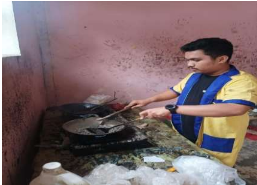
Proses Pemanasan aggregate Dan Pemanasan Aspal
