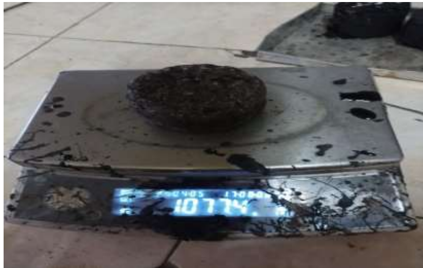
Hasil Pengujian Cantabro
