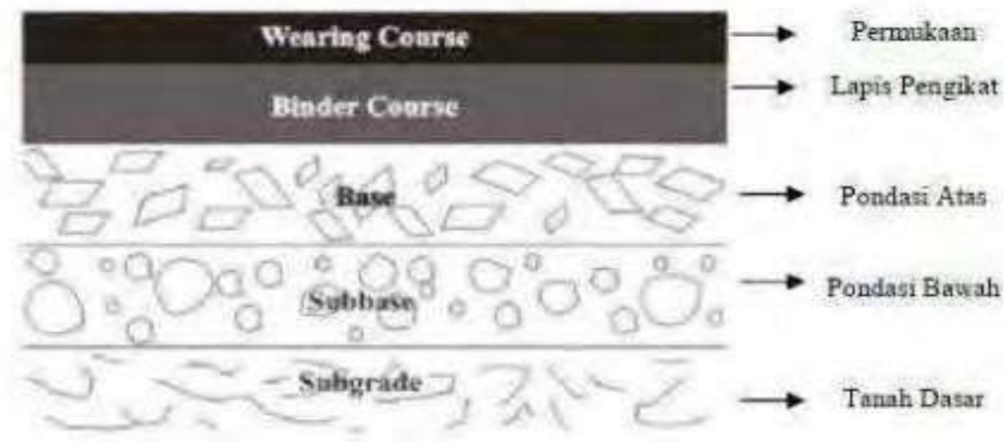
Gambar II. 1 Struktur perkerasan jalan lentur
