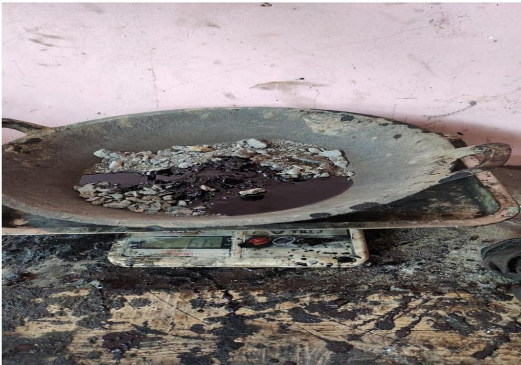
Pembuatan Benda Uji (Penambahan Aspal Pada Agregat)
