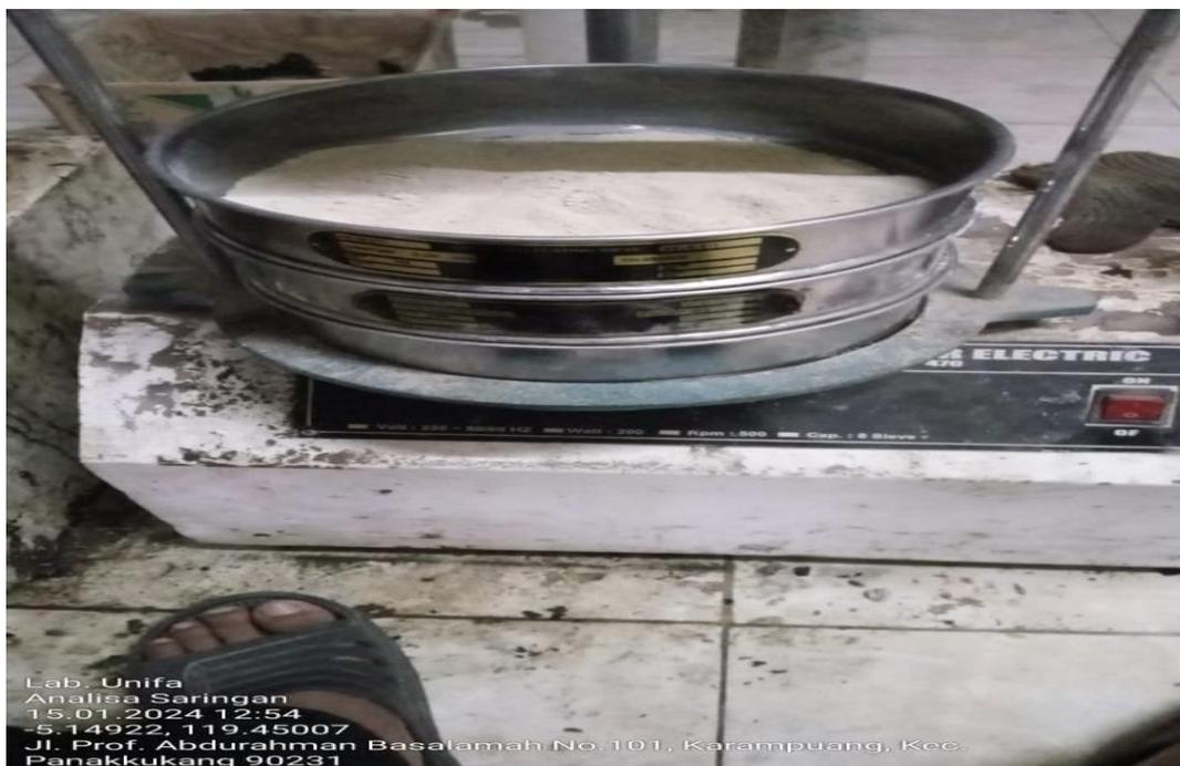
Proses Penyaringan Agregat
