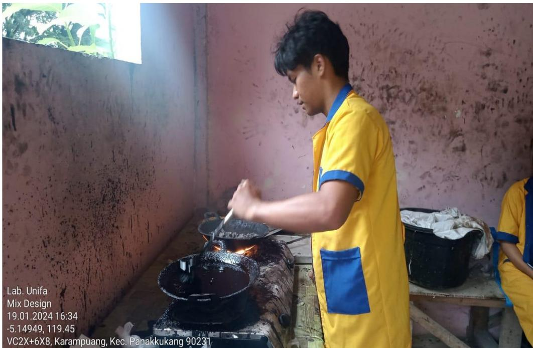
Pembuatan Benda Uji (Proses Mix Design Agregat)
