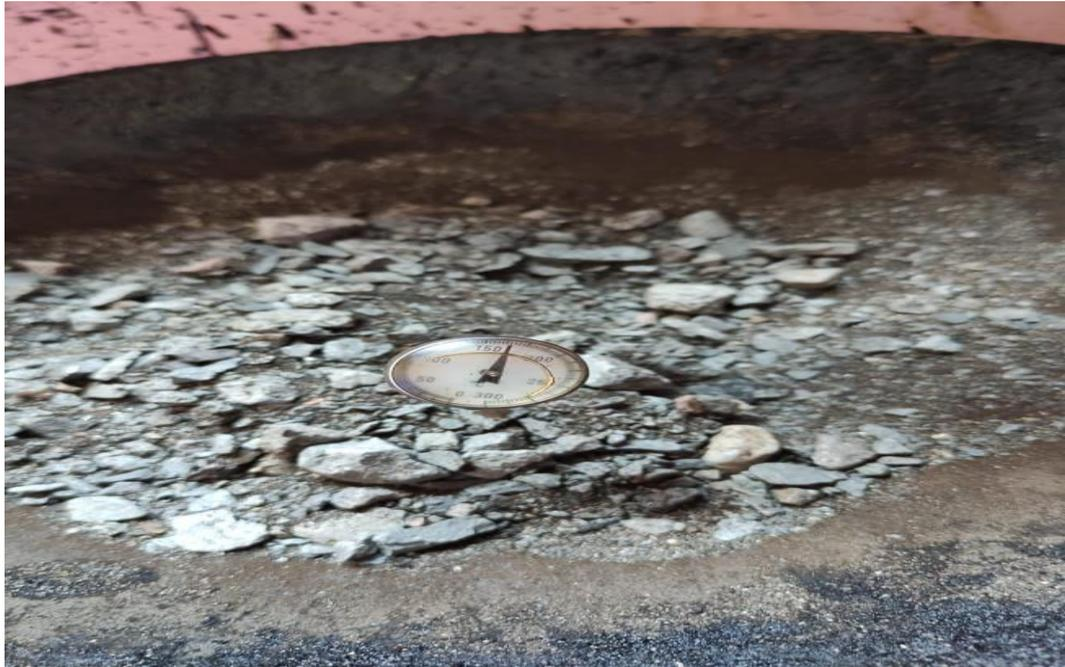
Pembuatan Benda Uji (Pengecekan Suhu Agregat)
