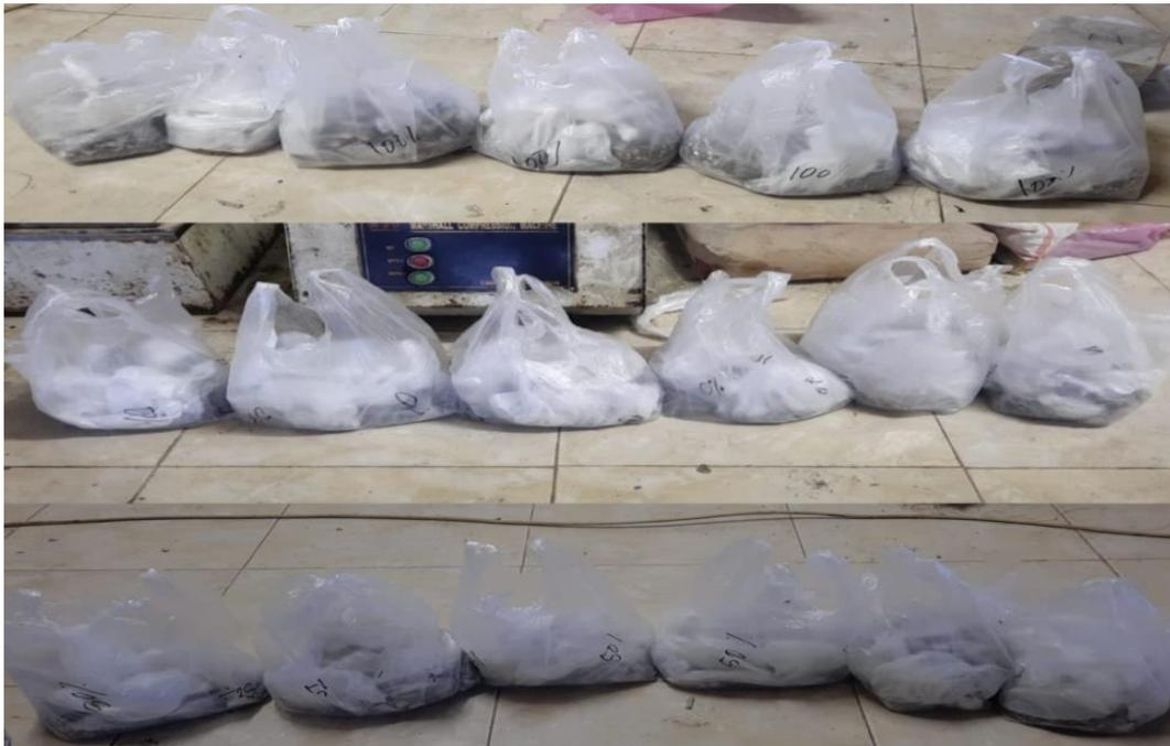
Pembuatan Benda Uji (Penimbangan Agregat)
