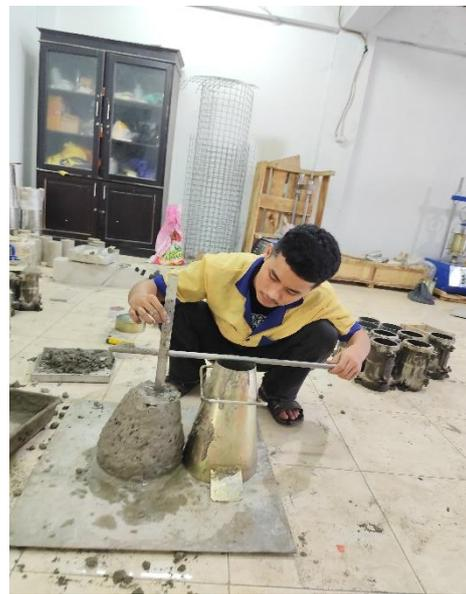
Gambar IV. 3 Pengujian Slump
