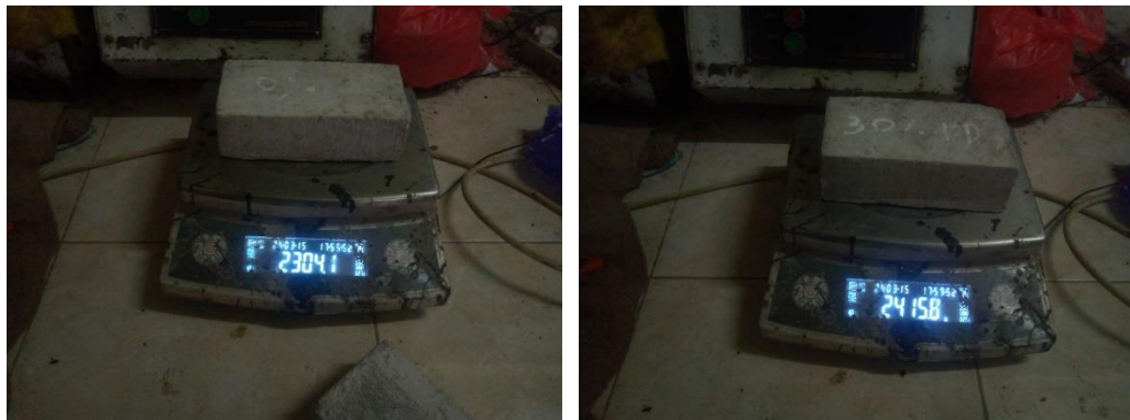
Proses Penimbangan Benda Uji Setelah di Oven dengan Menggunakan Timbangan Analitik
