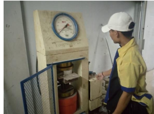
Gambar IV. 6 Proses Pengujian Kuat Tekan Paving Block
