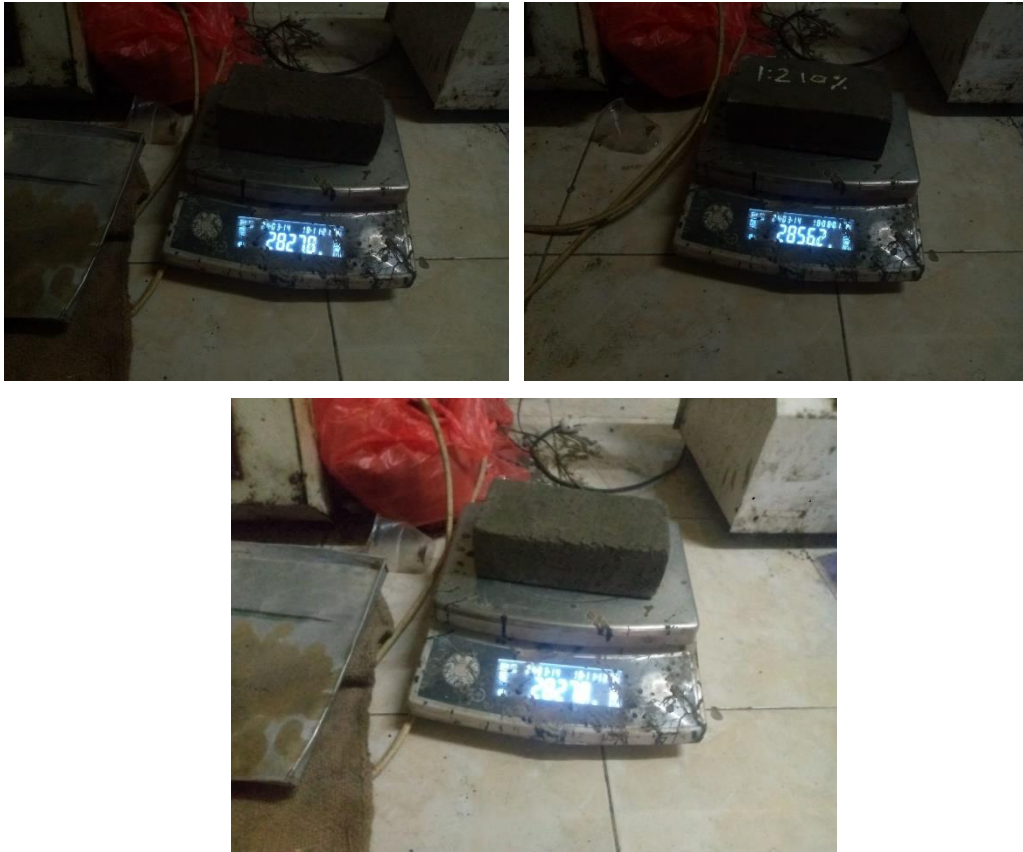
Proses Penimbangan Benda Uji Sebelum di Oven dengan Menggunakan Timbangan Analitik
