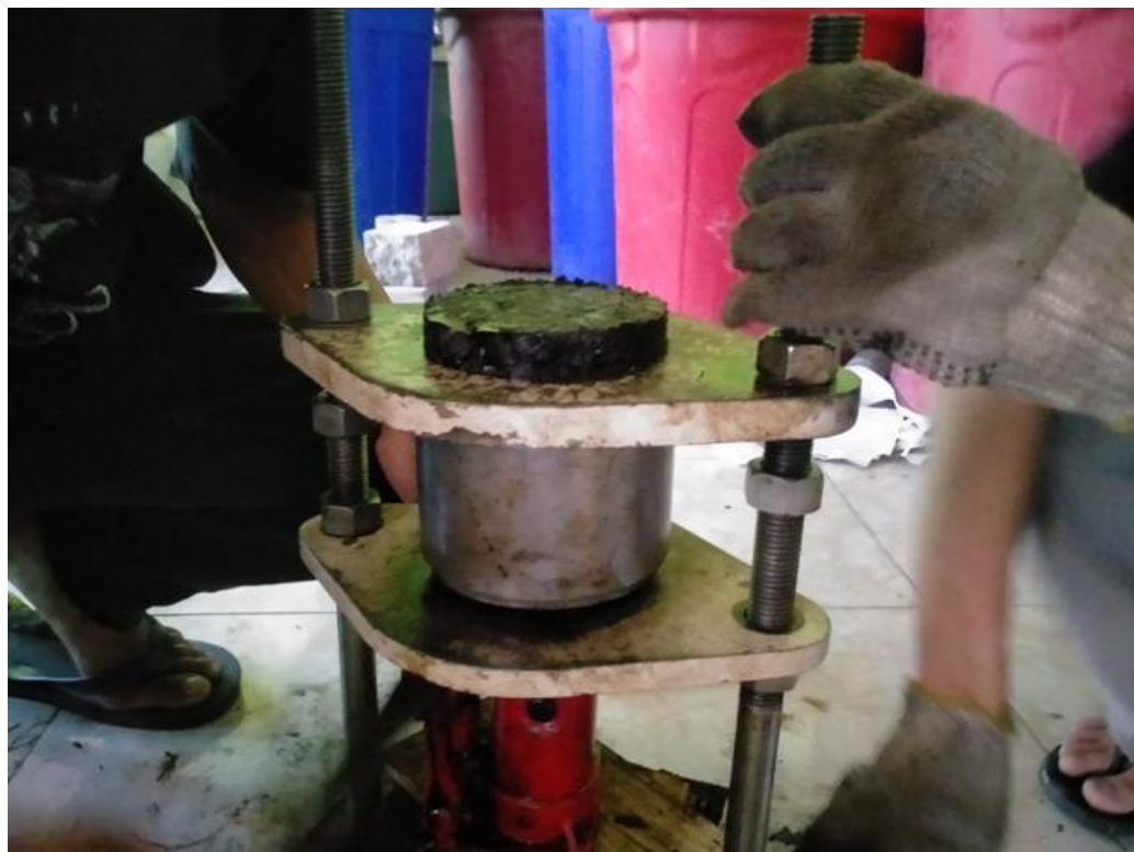
Sampel Dikeluarkan dari Mould Menggunakan Dongkrak
