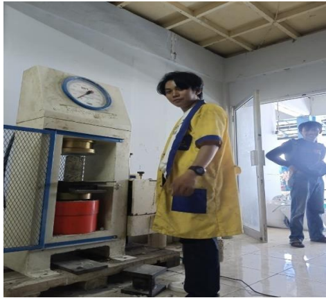
Pengujian benda uji beton berongga
