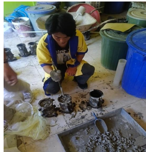
Campuran di masukkan kedalam cetakan silinder
