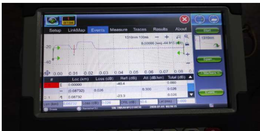
Gambar 9. Hasil pengukuran menggunakan OTDR pada jarak 87 m
