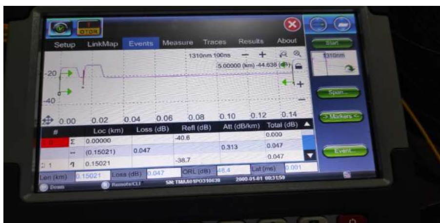
Gambar 10. Hasil pengukuran menggunakan OTDR pada jarak 150 m
