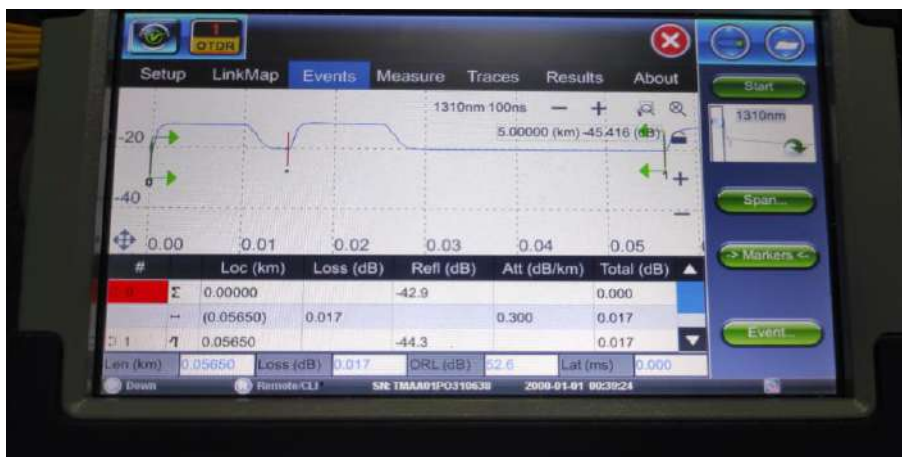
Gambar 8. Hasil pengukuran menggunakan OTDR pada jarak 56 m
