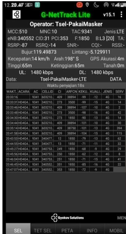
Gambar IV.9 Troughput uplink dan downlink pada bandwidth 45 Mhz
